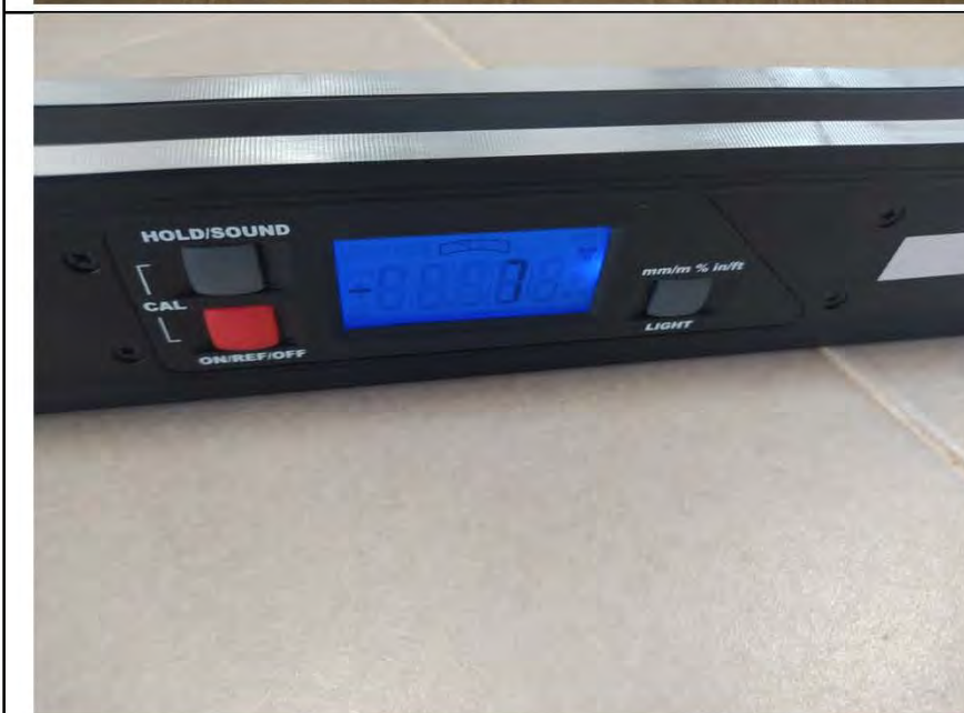
Фото №17. Измерение уровня напольного покрытия в прихожей (керамическая плитка).
