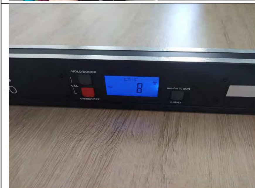
Фото №14. Измерение уровня напольного покрытия в спальне.
