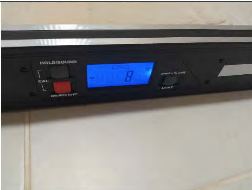
Фото №19. Измерение уровня напольного покрытия в санузле (керамическая плитка).
