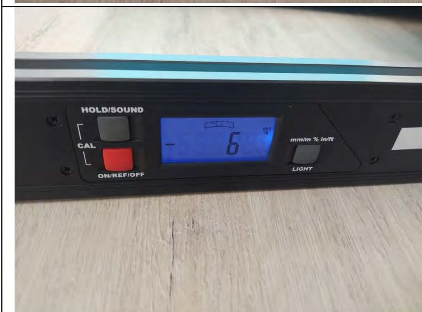
Фото №15. Измерение уровня напольного покрытия в гостиной.
