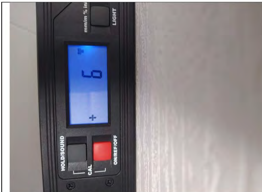
Фото №10. Измерение уровня стен в гостиной.
