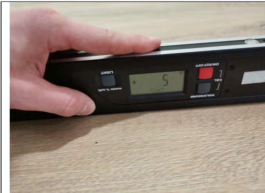
Фото №22. Измерение уровня пола в коридоре.
