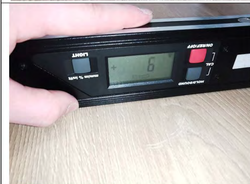
Фото №24. Измерение уровня пола в спальне.
