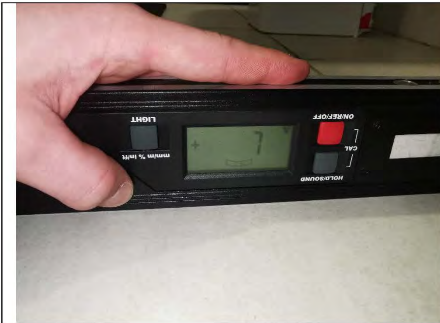
Фото №31. Измерение уровня пола в ванной комнате.
