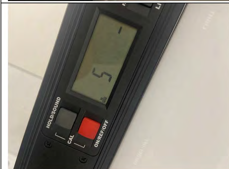
Фото №14. Отклонение поверхности стен от вертикали в санузле.
