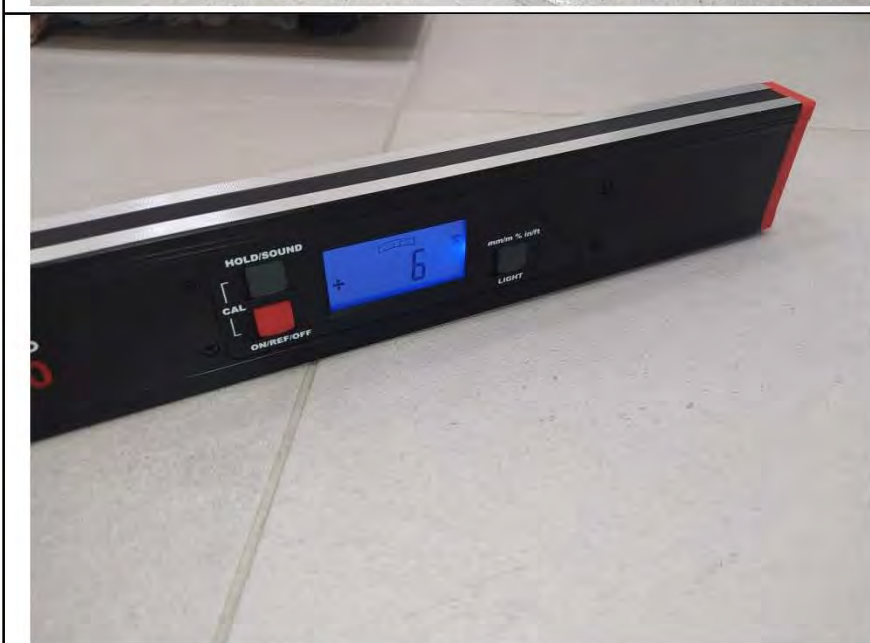
Фото №9. Измерения уровня напольного покрытия в ванной комнате (керамическая плитка).
