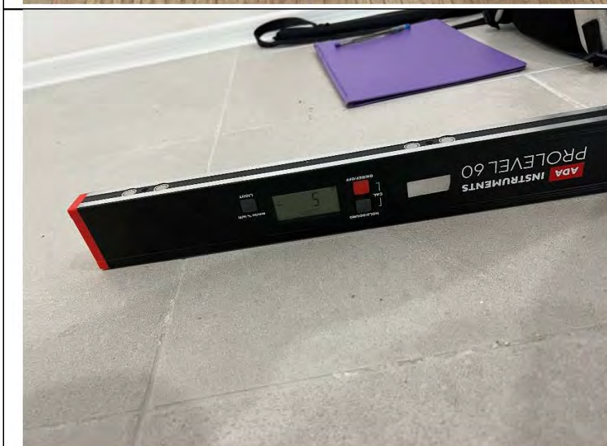
Фото №41. Измерение уровня напольного покрытия в коридоре.
