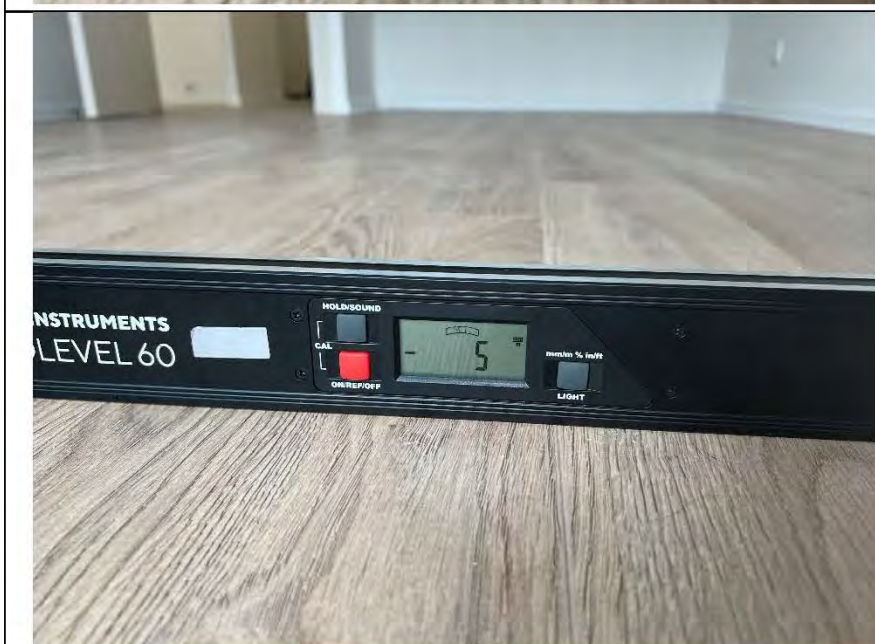
Фото №36. Измерение уровня напольного покрытия в детской.
