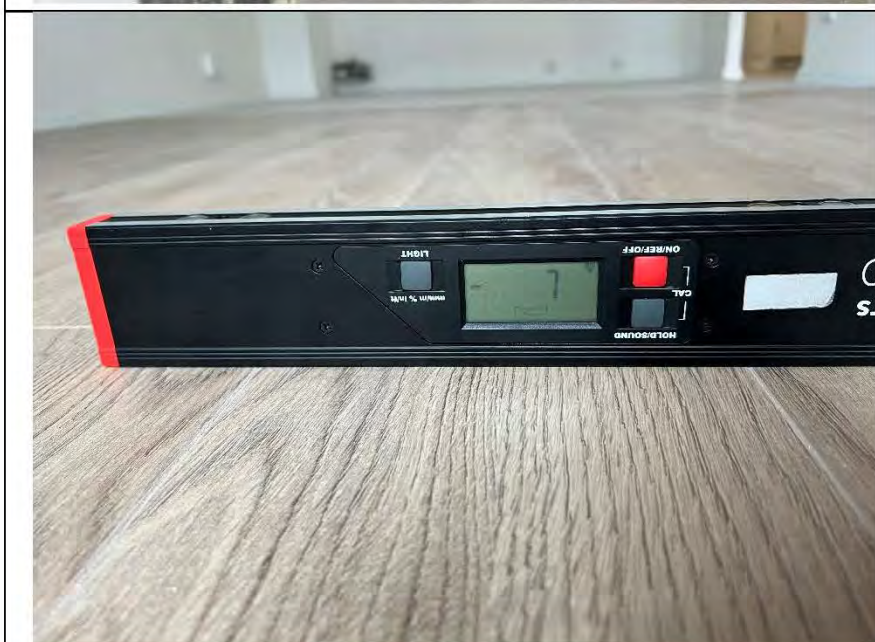
Фото №35. Измерение уровня напольного покрытия в кухне.
