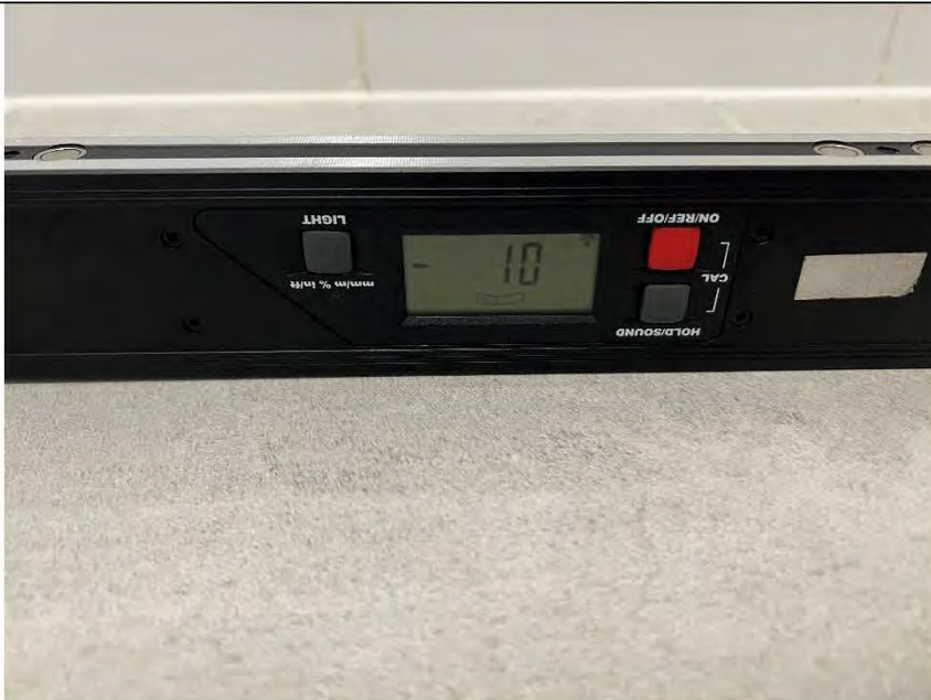
Фото №43. Измерение уровня напольного покрытия в ванной комнате.
