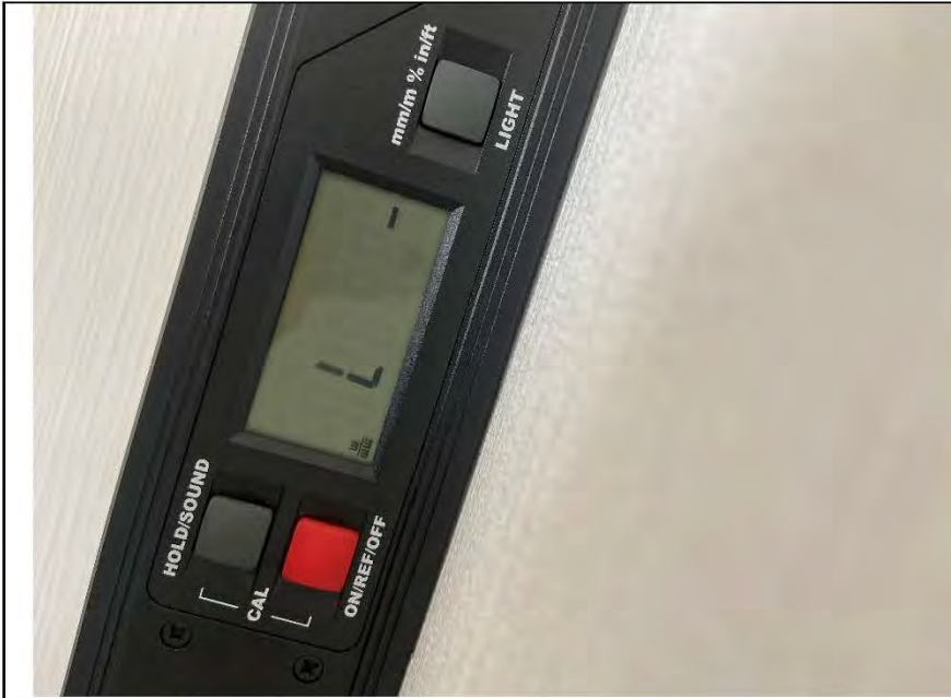
Фото №13. Отклонения поверхности стен от вертикали в кабинете.
