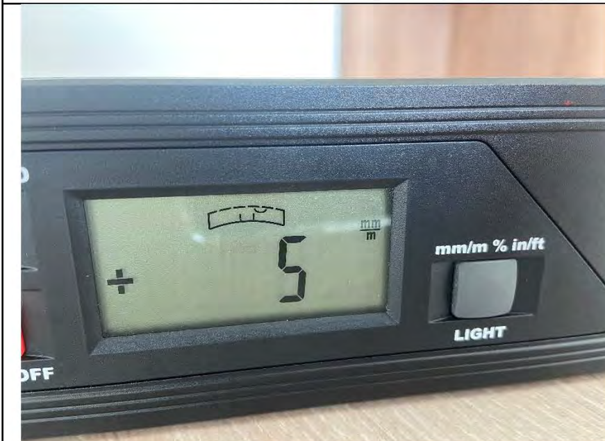
Фото №29. Отклонения поверхности напольного покрытия из ламината в кабинете.
