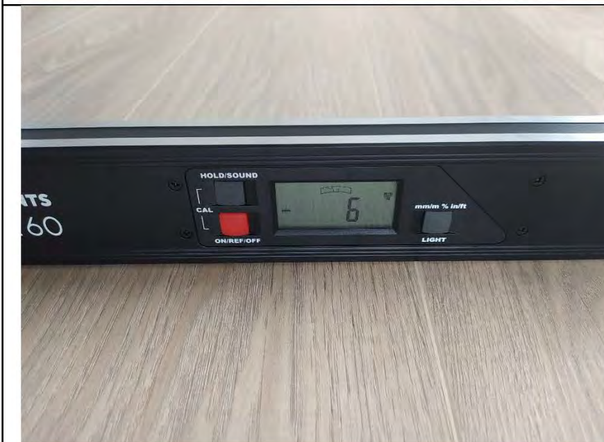
Фото №23. Измерение уровня напольного покрытия в гостиной.
