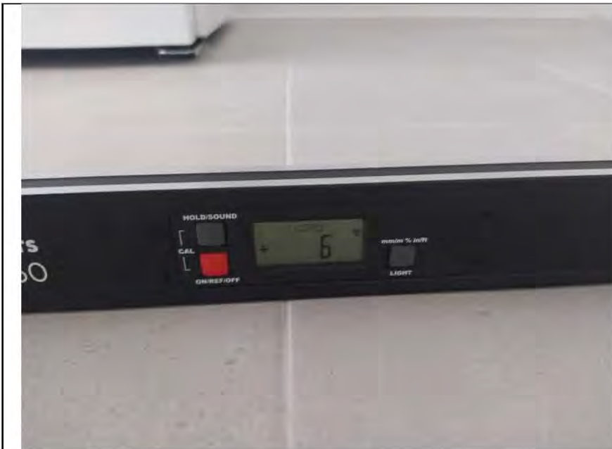
Фото №25. Измерение уровня напольного покрытия в кухне (керамическая плитка).
