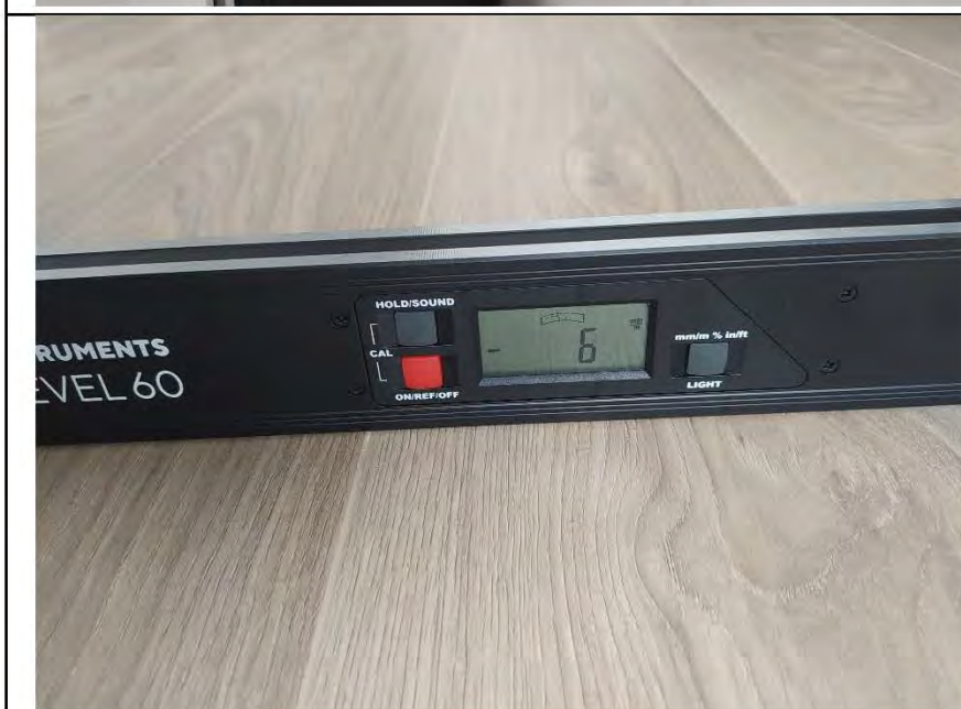
Фото №20. Измерение уровня напольного покрытия в спальне.
