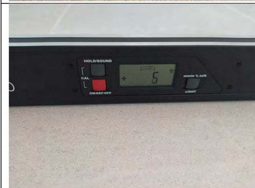
Фото №24. Измерение уровня напольного покрытия в прихожей (керамическая плитка).
