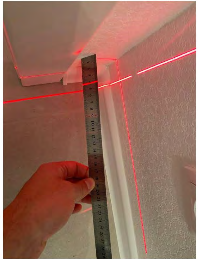
Фото 18, 19. Коридор (6,5 кв.м.) 1.5 Отклонения участка стены от вертикали 6 мм
