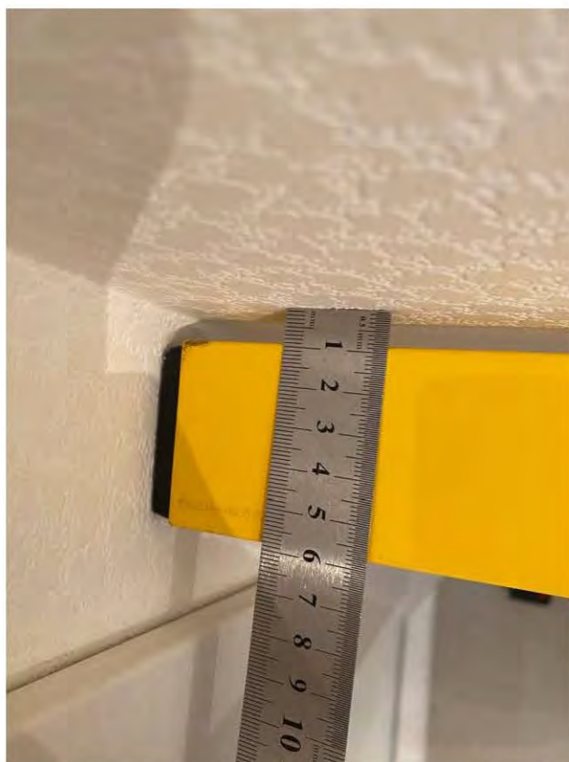
Фото 16, 17. Коридор (6,5 кв.м.) 1.4 Отклонения участков стен от горизонтали 9 мм, 4,5 мм
