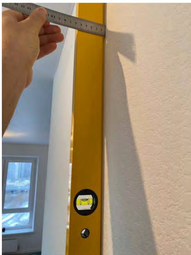
Фото 43, 44. Кухня (16,3 кв.м.) 3.7 Отклонения участков стен от горизонтали 6,5 мм, 5 мм
