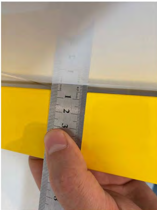
Фото 25, 26. Санузел (3,5 кв.м.) 2.3 Отклонение настенной плитки от плоскости на участках стен 9 мм, 5 мм
