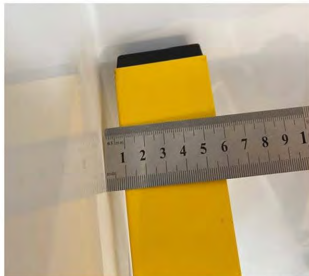
Фото 25, 26. Санузел (3,5 кв.м.) 2.3 Отклонение настенной плитки от плоскости на участках стен 9 мм, 5 мм
