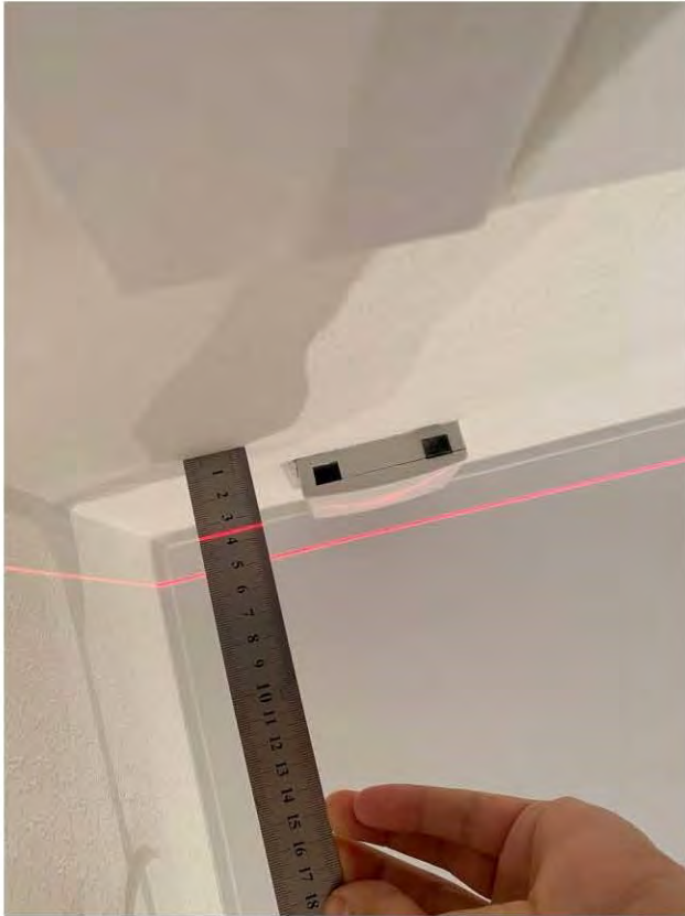
Фото 18, 19. Коридор (6,5 кв.м.) 1.5 Отклонения участка стены от вертикали 6 мм
