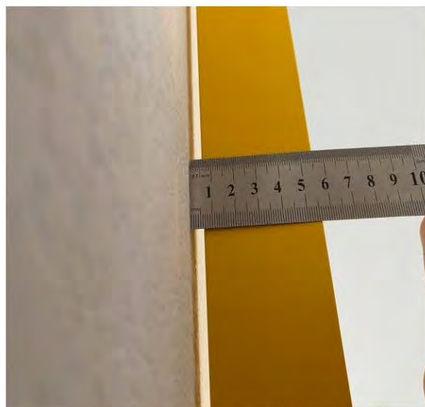
Фото 43, 44. Кухня (16,3 кв.м.) 3.7 Отклонения участков стен от горизонтали 6,5 мм, 5 мм
