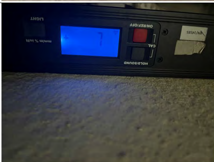
Фото №18. Измерение уровня пола в ванной комнате.
