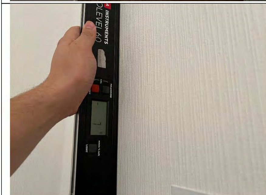
Фото №8. Измерение уровня стен в кухне.
