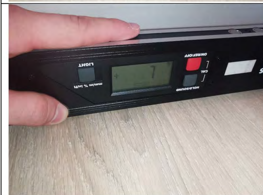
Фото №21. Измерение уровня пола в спальне.
