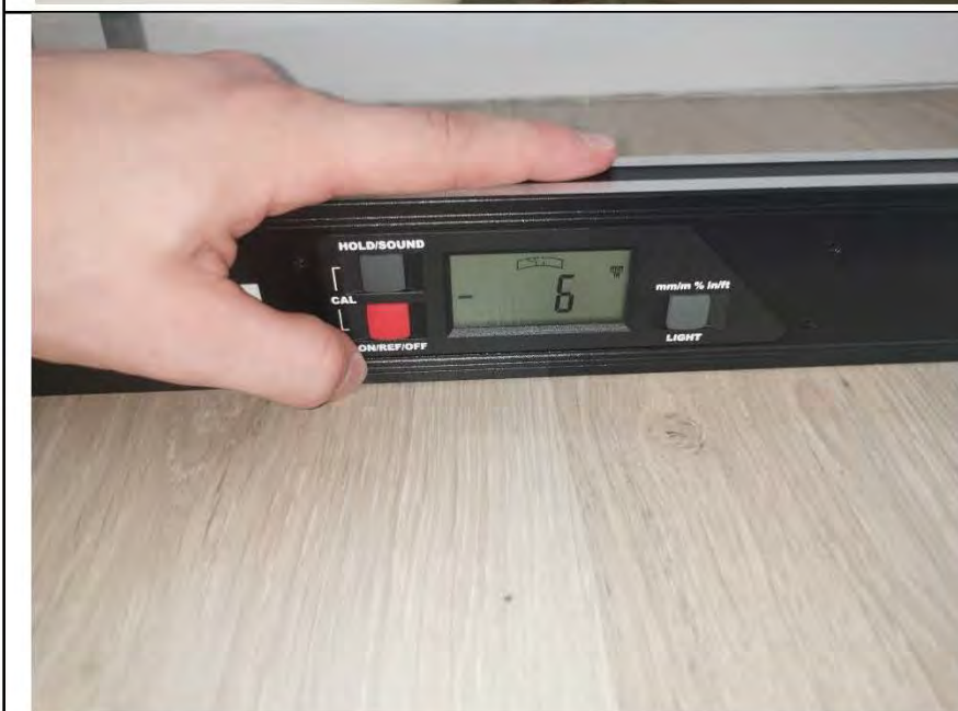
Фото №20. Измерение уровня пола в спальне.
