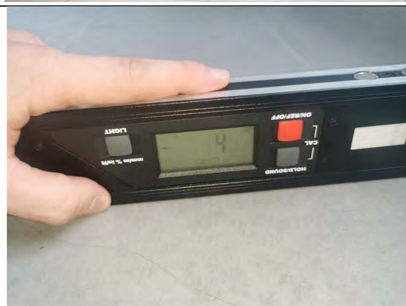
Фото №30. Измерение уровня пола на лоджии.
