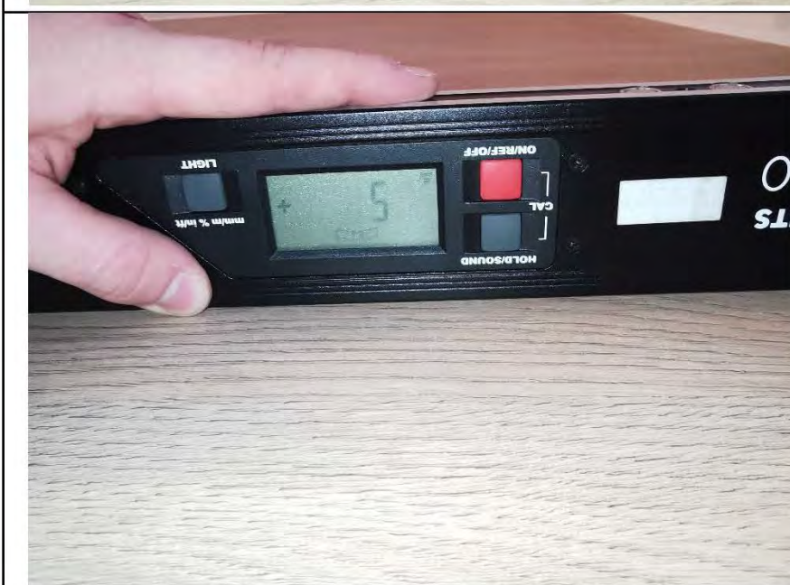
Фото №45. Измерение уровня пола в спальне.
