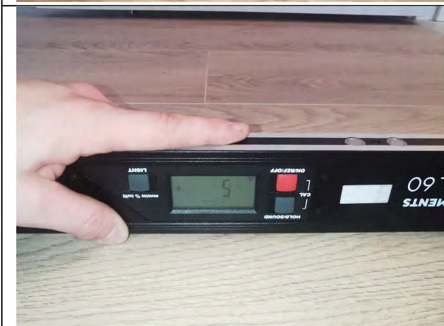
Фото №44. Измерение уровня пола в гостиной.
