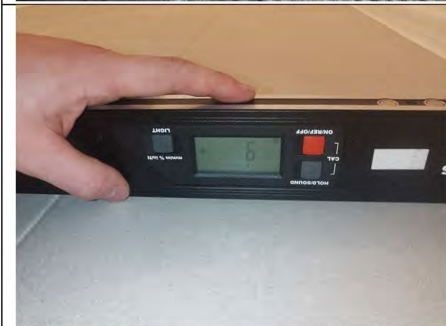
Фото №56. Измерение уровня пола в прихожей.
