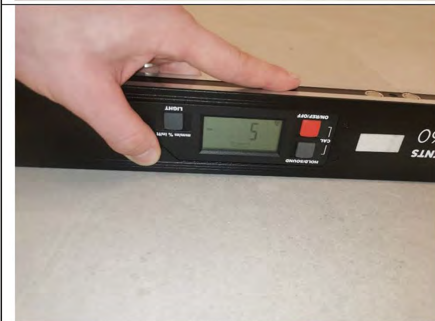
Фото №59. Измерение уровня пола в кухне.
