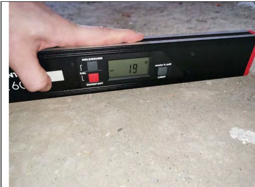
Фото №13. Измерение уровня пола в помещении.
