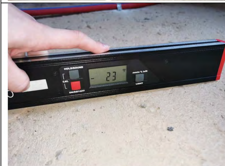
Фото №14. Измерение уровня пола в помещении.
