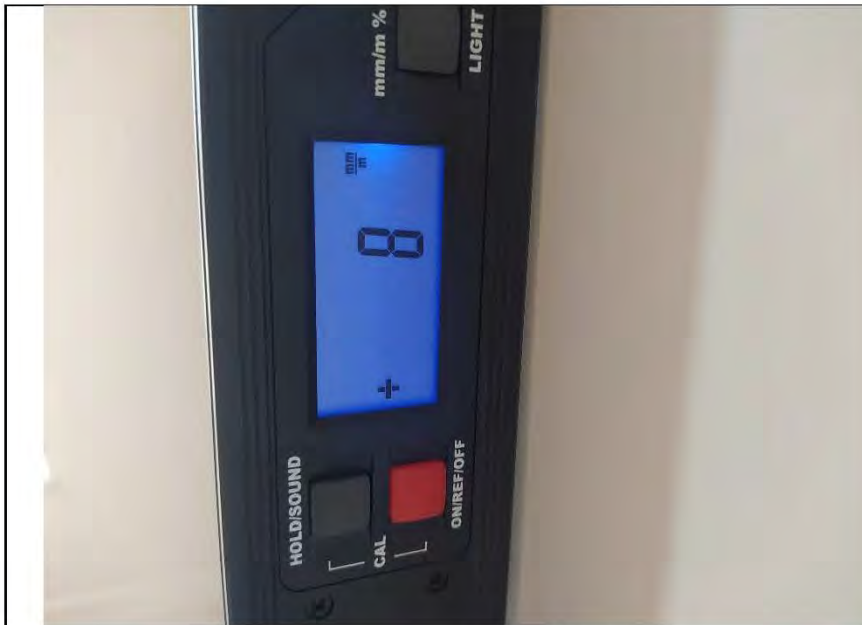
Фото №7. Измерение уровня стен в кухне.
