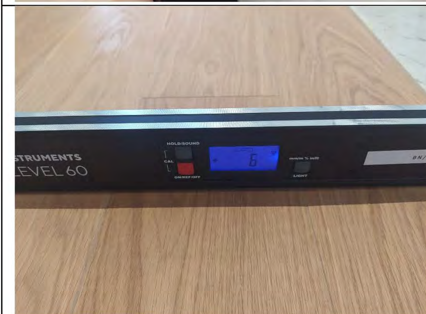
Фото №11. Измерение уровня напольного покрытия в кухне.
