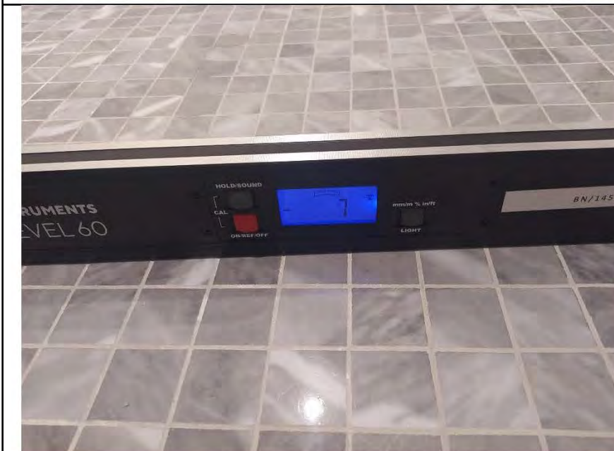
Фото №15. Измерение уровня напольного покрытия в санузле (керамическая плитка).
