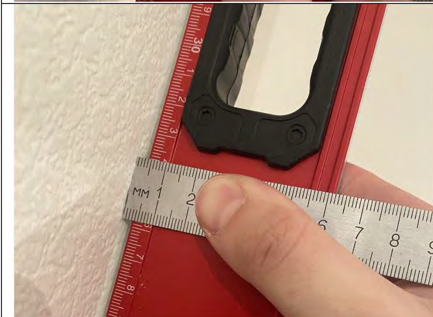
Фото №15. Измерение уровня стен в кладовой в квартире.
