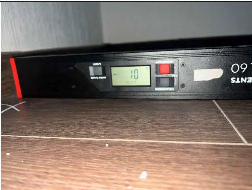
Фото №35. Измерение уровня напольного покрытия в спальне.
