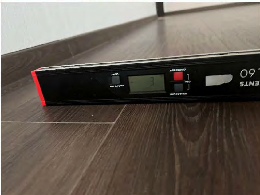
Фото №36. Измерение уровня напольного покрытия в гостиной.
