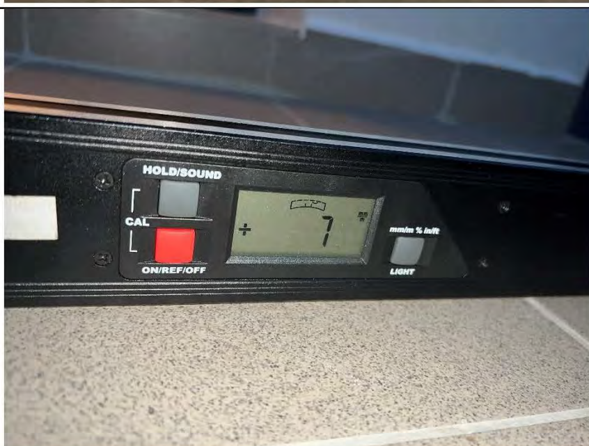
Фото №42. Измерение уровня напольного покрытия на лоджии.
