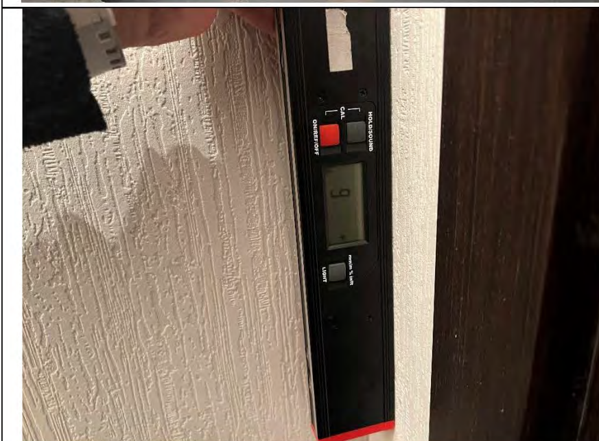
Фото №11. Измерение уровня стен в гардеробной.
