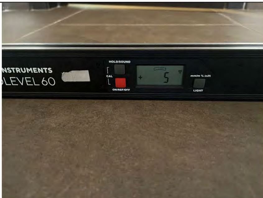
Фото №41. Измерение уровня напольного покрытия в кухне.
