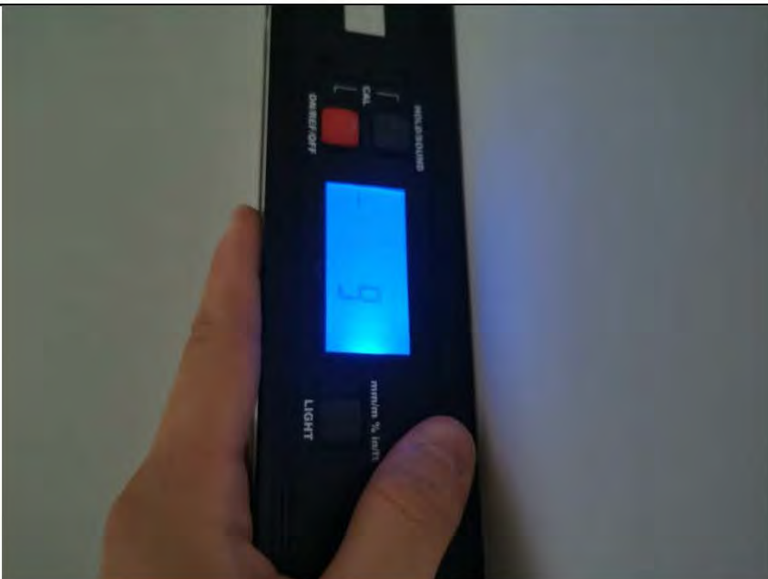
Фото №8. Измерение уровня стен в коридоре.
