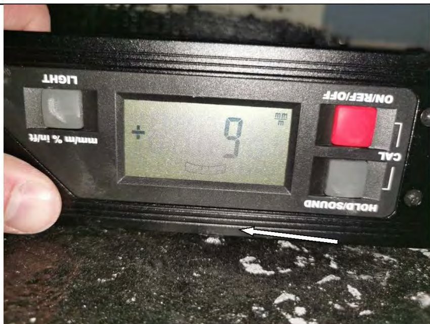
Фото №14. Измерение уровня пола в ванной комнате.
