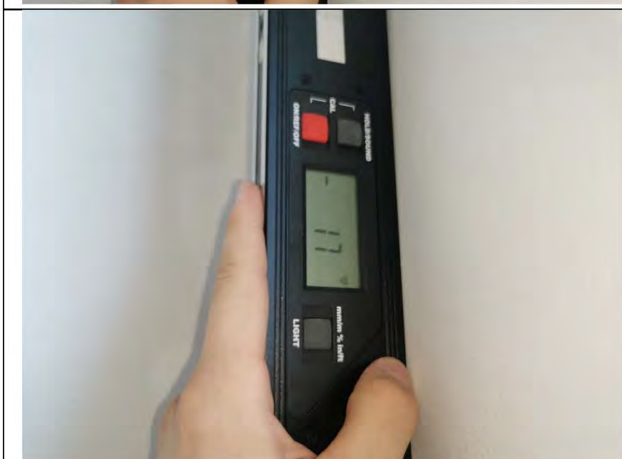
Фото №11. Измерение уровня стен в спальне.
