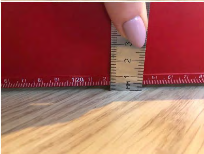
Фото №12. Измерение уровня ламината пола детской в квартире.
