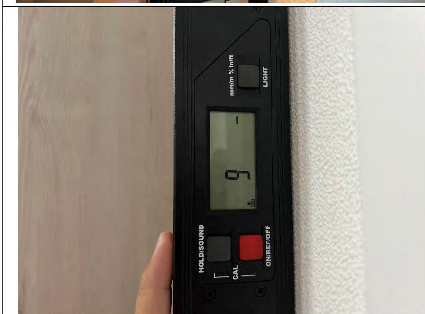
Фото №9. Измерение уровня стен в спальне.
