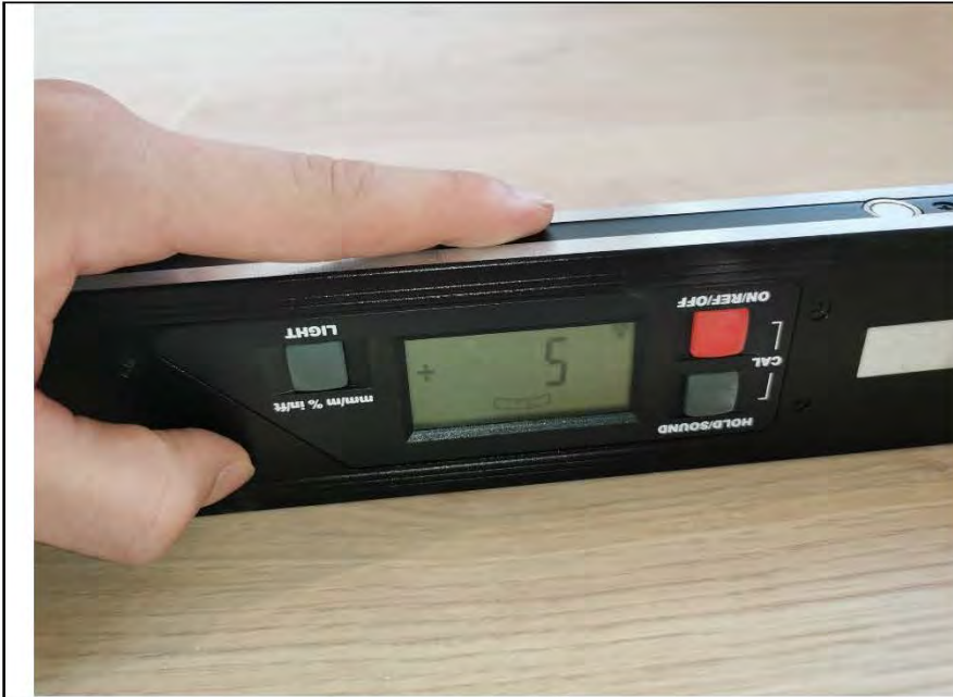
Фото №25. Измерение уровня пола в кухне.
