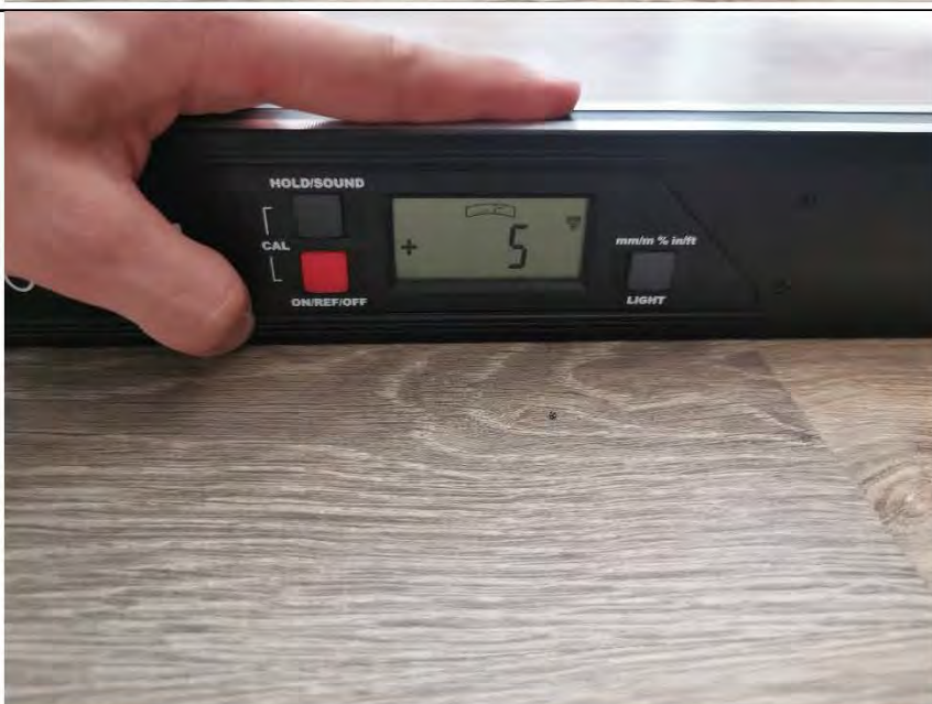
Фото №18. Измерение уровня пола в комнате.
