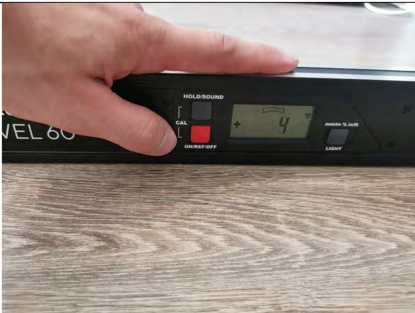
Фото №17. Измерение уровня пола в коридоре.
