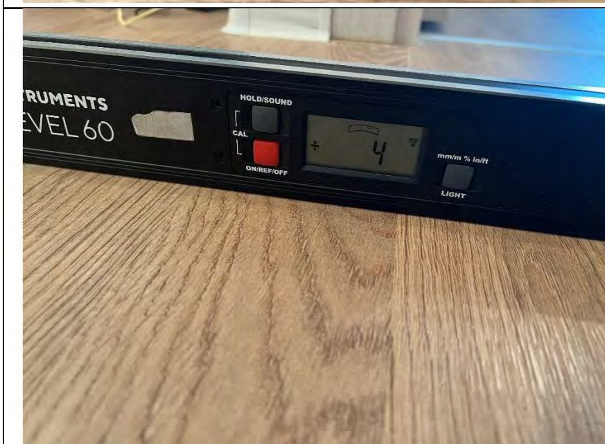
Фото №18. Измерение уровня напольного покрытия в коридоре.
