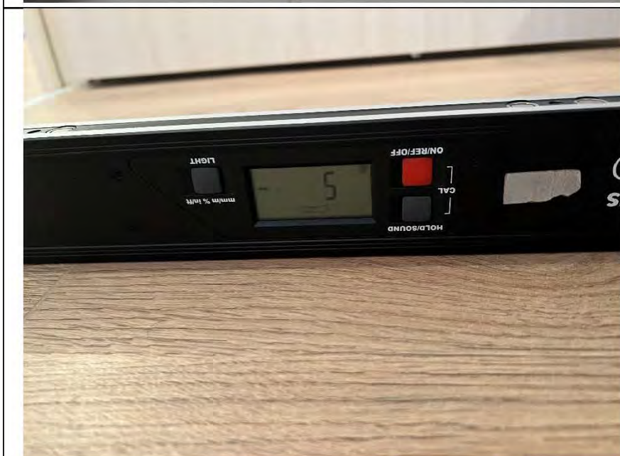
Фото №17. Измерение уровня напольного покрытия в спальне.
