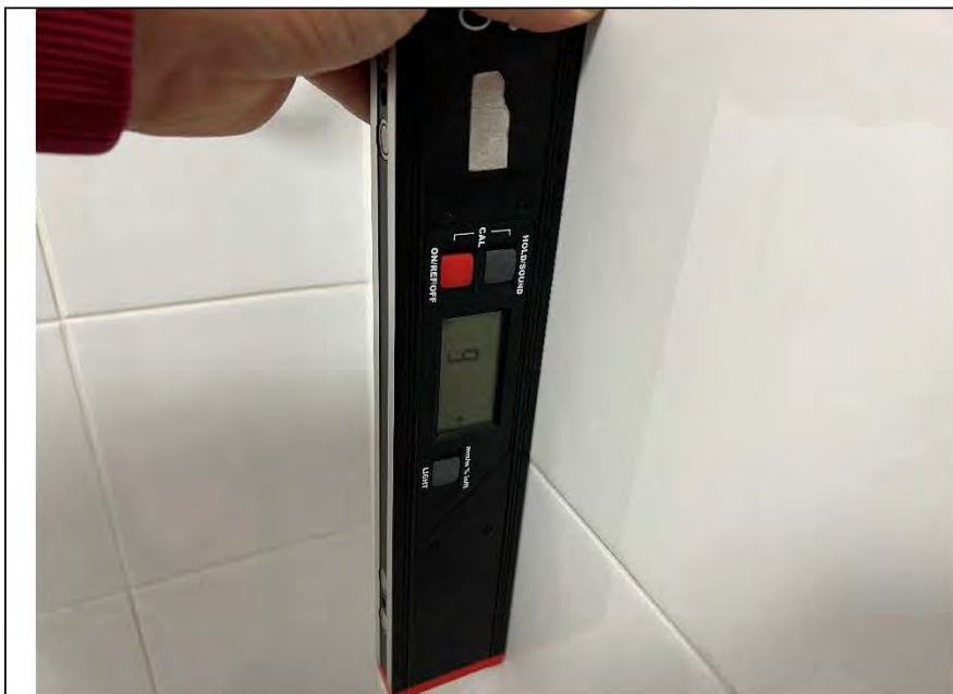
Фото №13. Измерение уровня стен в ванной комнате.
