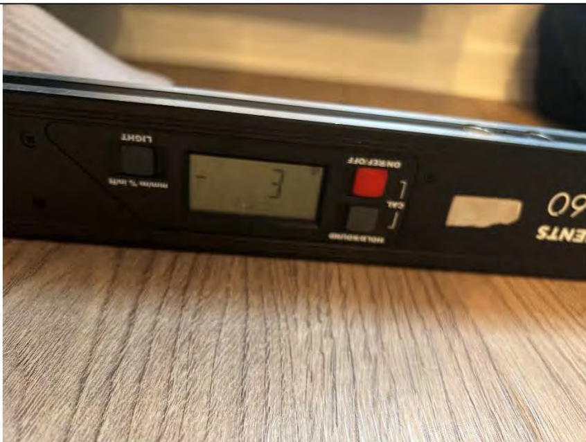
Фото №19. Измерение уровня напольного покрытия в кухне.
