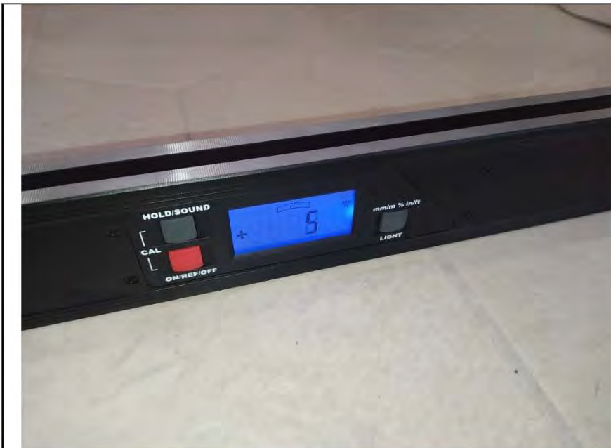
Фото №19. Измерения уровня напольного покрытия в ванной комнате (керамическая плитка).
