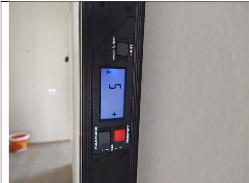
Фото №10. Измерения уровня стен в прихожей.
