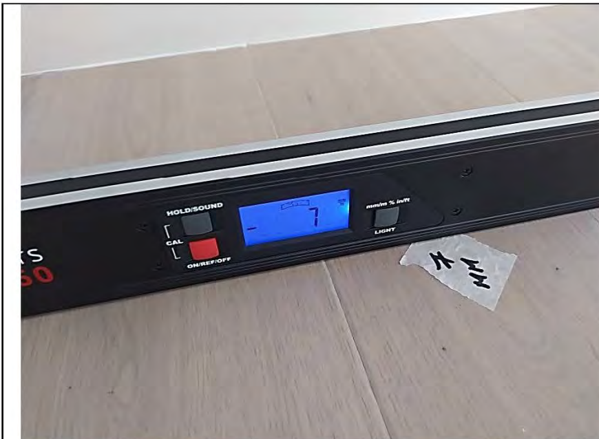
Фото №13. Измерения уровня напольного покрытия в спальне.
