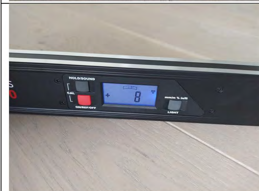
Фото №14. Измерения уровня напольного покрытия в гостиной.
