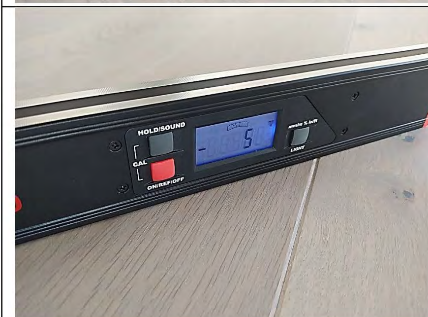
Фото №15. Измерения уровня напольного покрытия в кухне (паркет).
