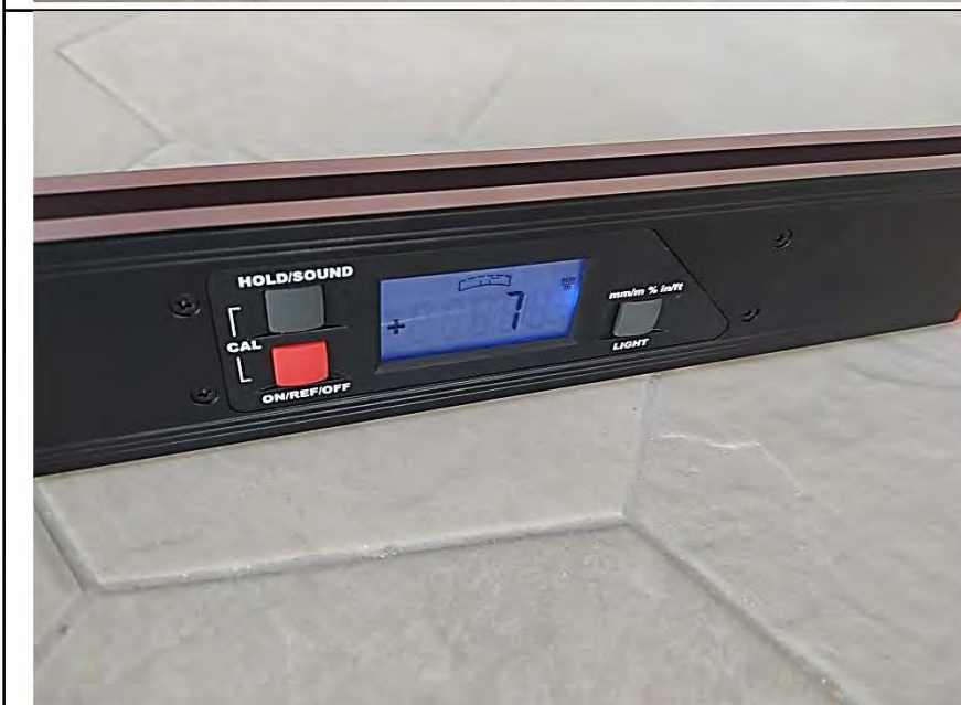
Фото №18. Измерения уровня напольного покрытия в кухне (керамическая плитка).
