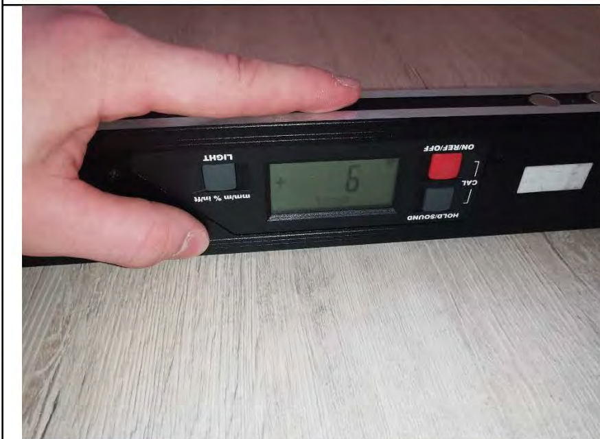
Фото №17. Измерение уровня пола в комнате.
