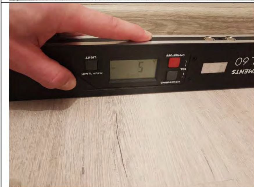
Фото №18. Измерение уровня пола в гардеробе.
