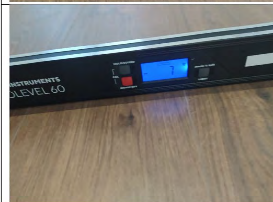
Фото №15. Измерение уровня напольного покрытия в спальне.
