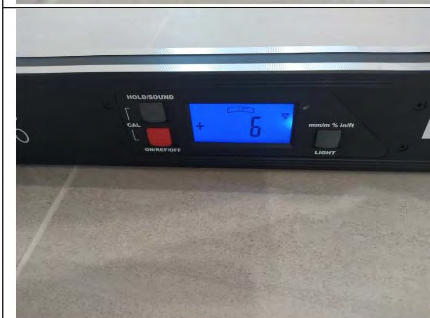
Фото №18. Измерение уровня напольного покрытия в кухне (керамическая плитка).
