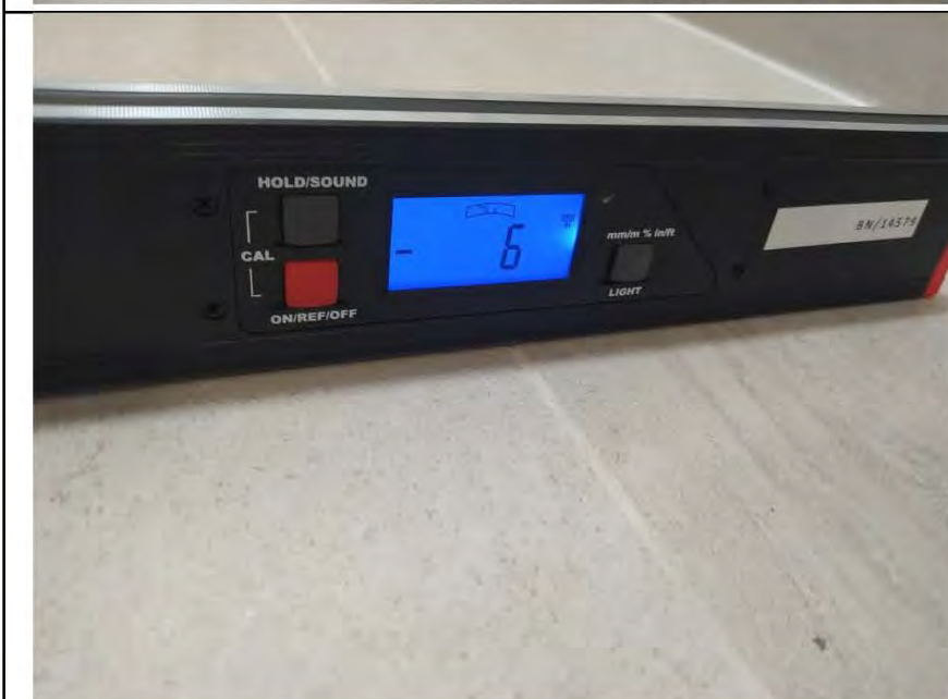
Фото №20. Измерение уровня напольного покрытия в санузле (керамическая плитка).
