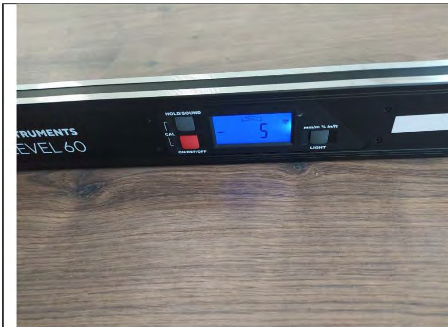
Фото №16. Измерение уровня напольного покрытия в кухне.
