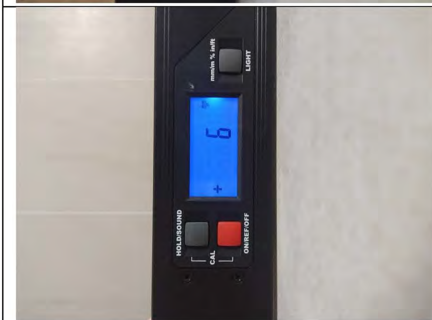
Фото №12. Измерение уровня стен в ванной комнате (керамическая плитка).
