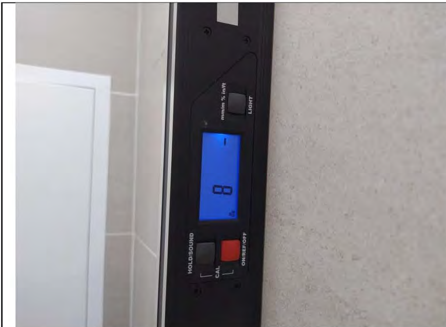
Фото №13. Измерение уровня стен в санузле (керамическая плитка).
