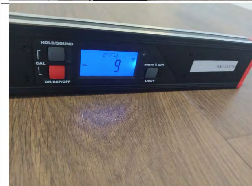
Фото №14. Измерение уровня напольного покрытия в гостиной.
