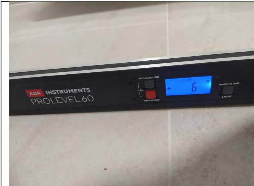
Фото №19. Измерение уровня напольного покрытия в ванной комнате (керамическая плитка).
