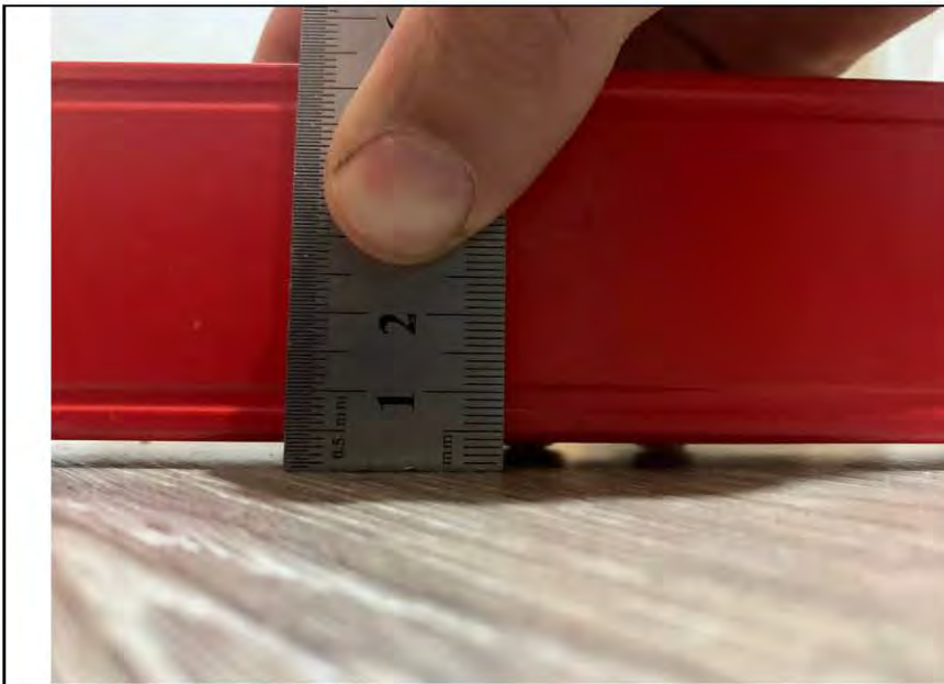
Фото №16. Отклонение уровня пола в прихожей.
