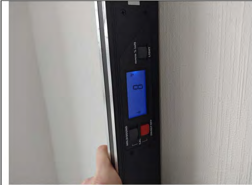
Фото №13. Измерение уровня стен в кабинете.
