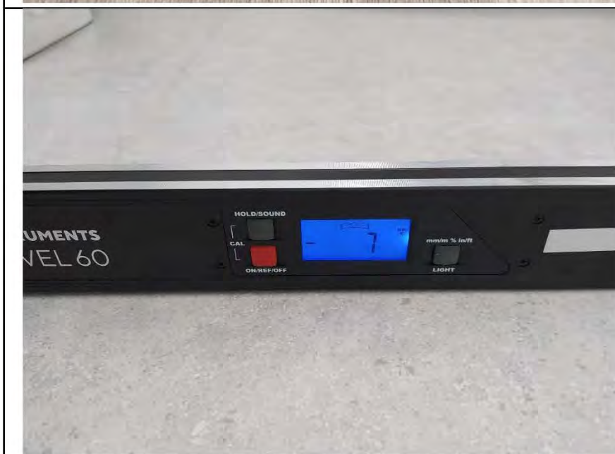
Фото №21. Измерение уровня напольного покрытия в ванной комнате (керамическая плитка).
