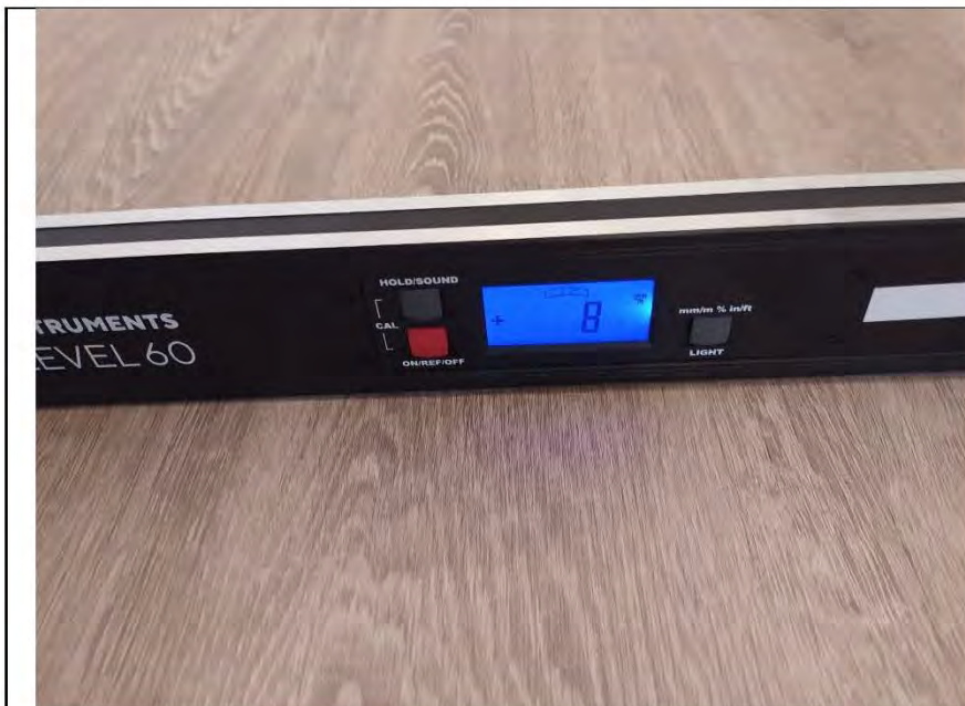
Фото №19. Измерение уровня напольного покрытия в прихожей.
