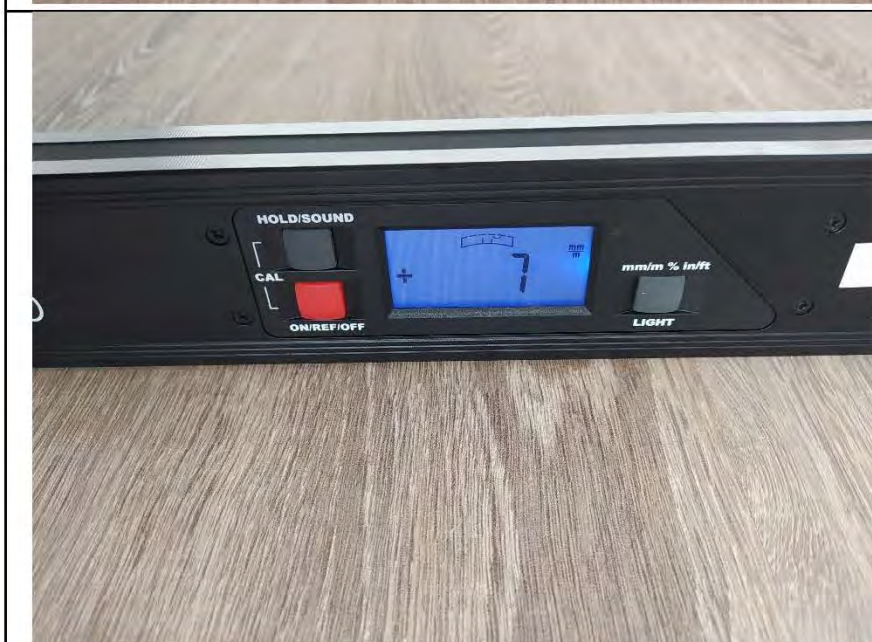
Фото №20. Измерение уровня напольного покрытия в кабинете.
