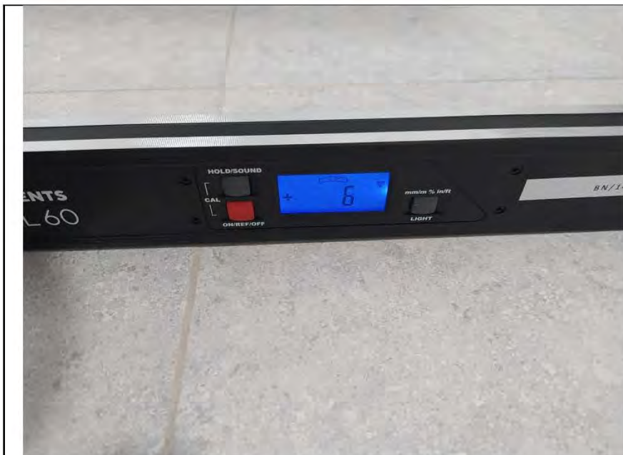
Фото №22. Измерение уровня напольного покрытия в санузле (керамическая плитка).
