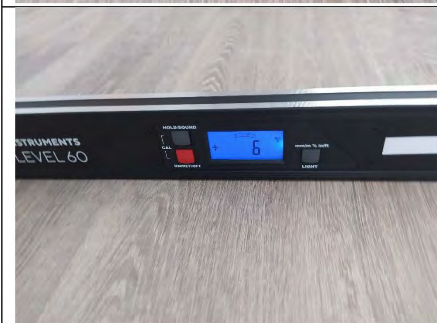
Фото №18. Измерение уровня напольного покрытия в кухне.
