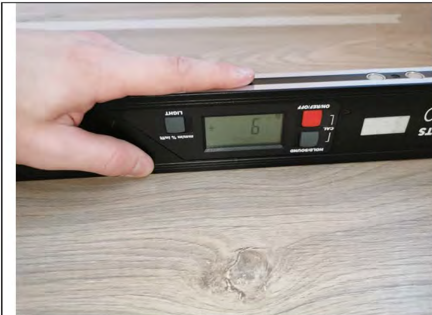
Фото №16. Измерение уровня пола в комнате.
