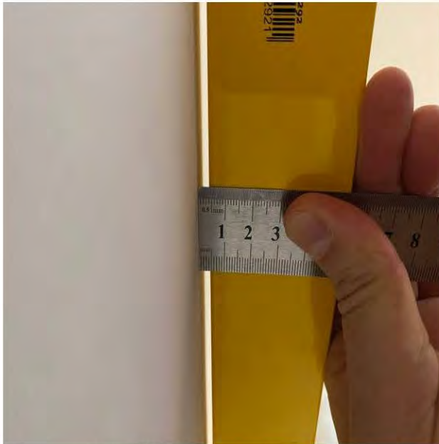
Фото 18, 19. Коридор. 1.2 Отклонения участков стен от горизонтали 4,5 мм, 7 мм
