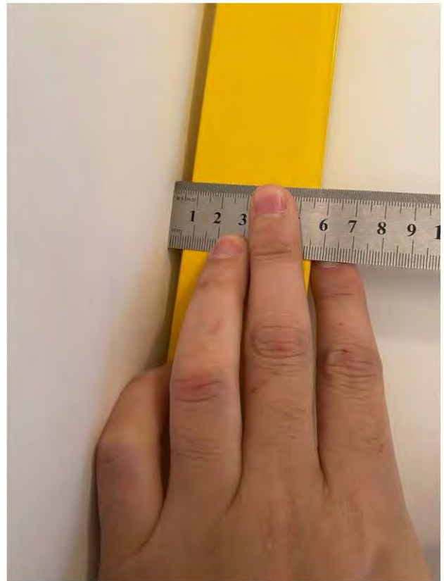
Фото 18, 19. Коридор. 1.2 Отклонения участков стен от горизонтали 4,5 мм, 7 мм
