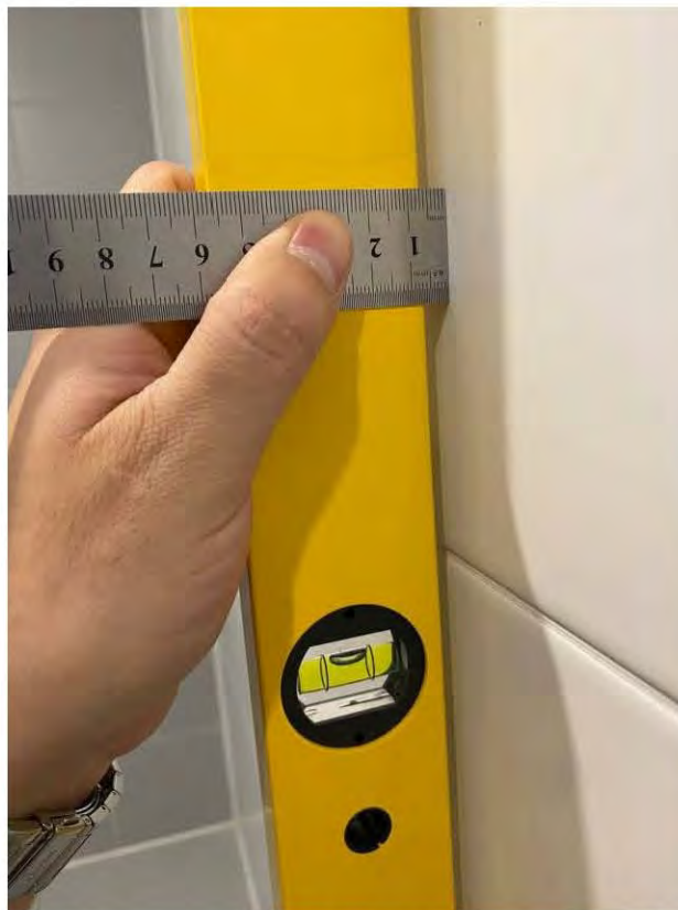
Фото 47, 48. Санузел. 5.2 Отклонение на участках стен из керамической плитки от вертикали 7 мм, 7 мм
