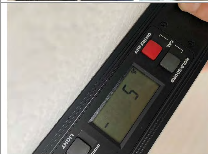
Фото №12. Измерение уровня стен в спальне.
