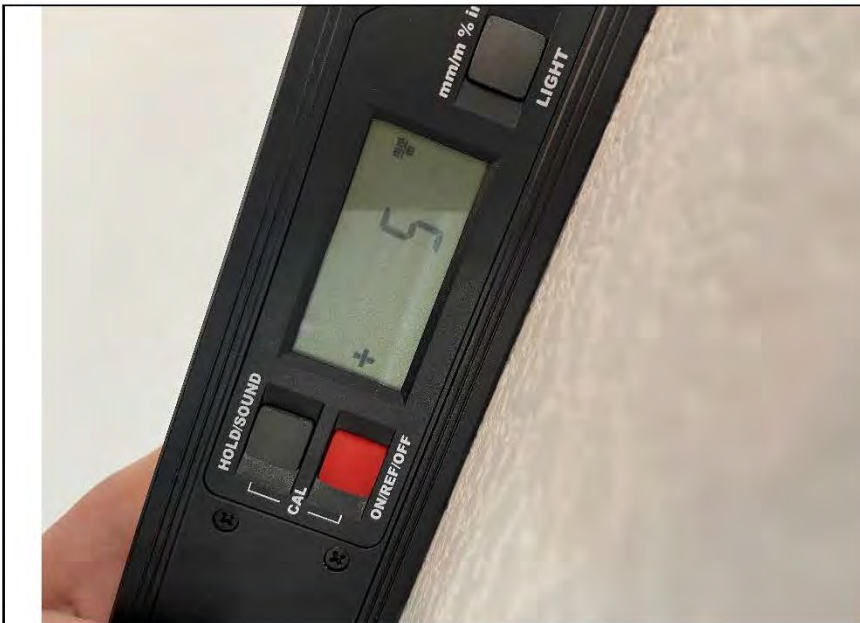
Фото №10. Измерение уровня стен в кухне.
