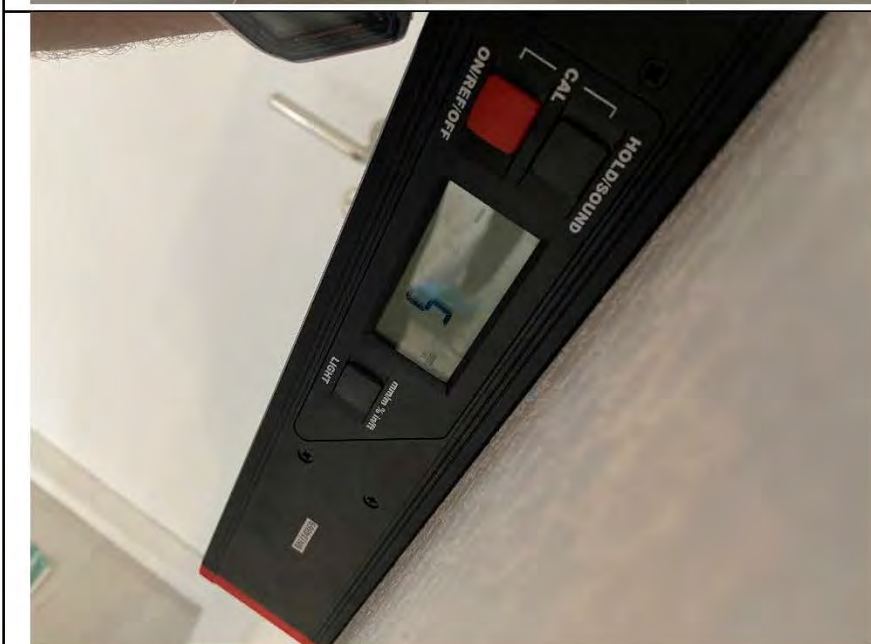
Фото №9. Измерение уровня стен в прихожей.
