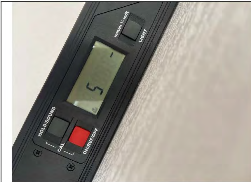
Фото №10. Измерение уровня стен в спальне.
