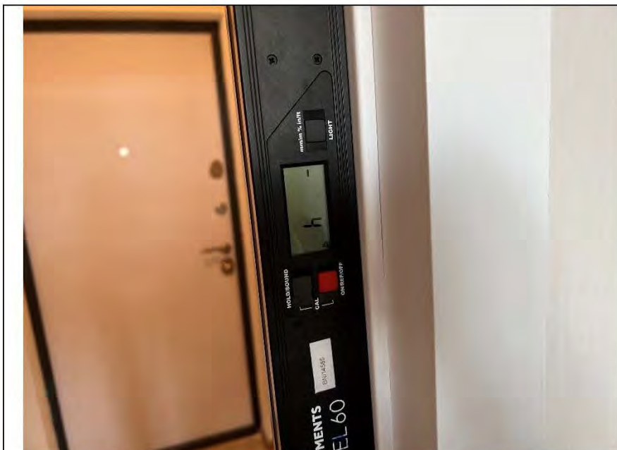
Фото №31. Отклонение от плоскостности и прямолинейности дверного блока в кухне- гостиной равно 4 мм.
