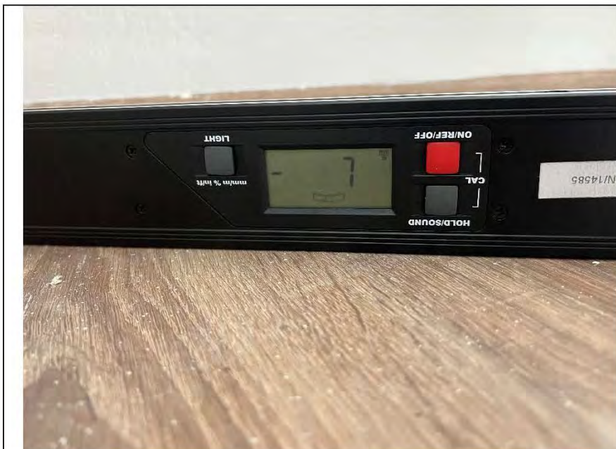
Фото №10. Измерение уровня напольного покрытия в кухне-гостиной.
