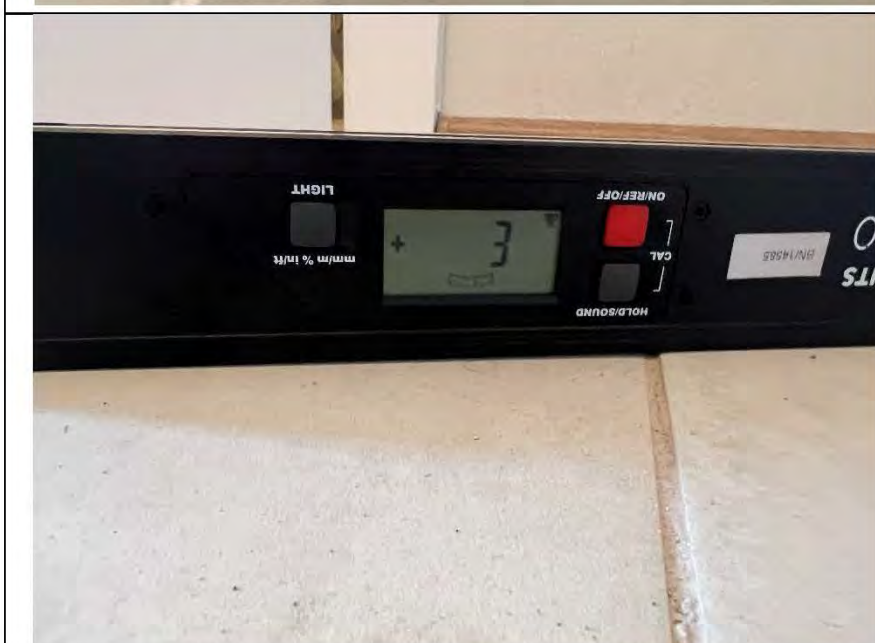
Фото №12. Измерение уровня напольного покрытия в коридоре.
