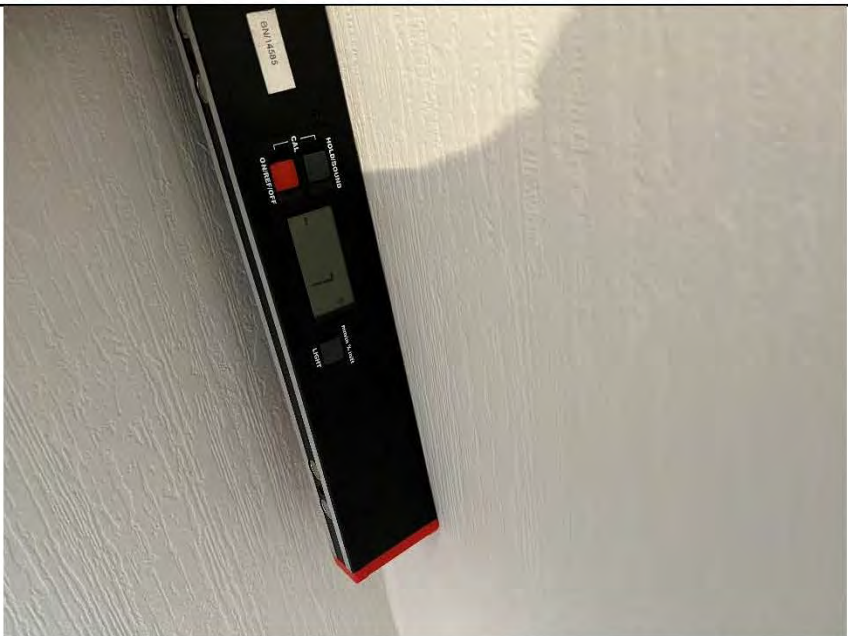
Фото №5. Измерение уровня стен в коридоре.
