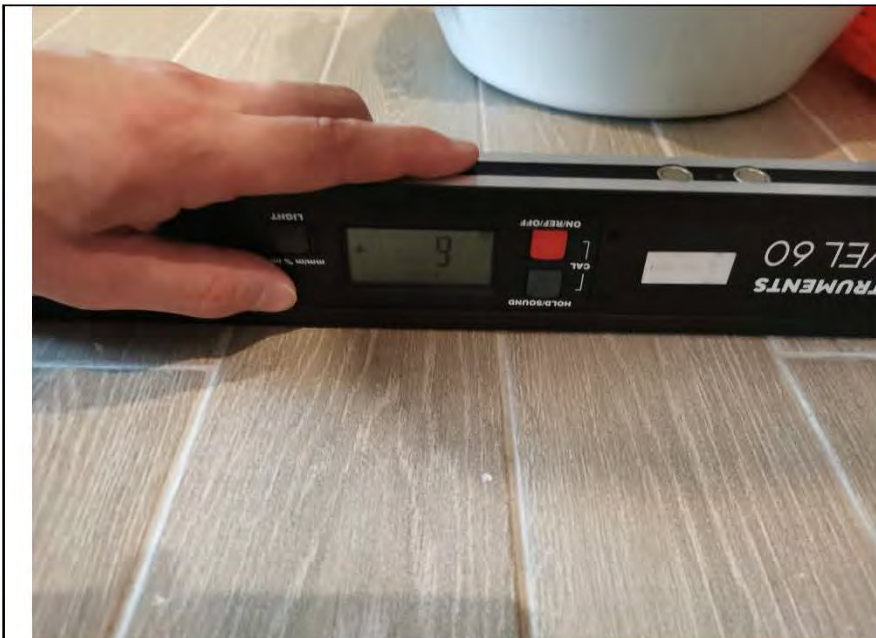
Фото №31. Измерение уровня пола в санузле.
