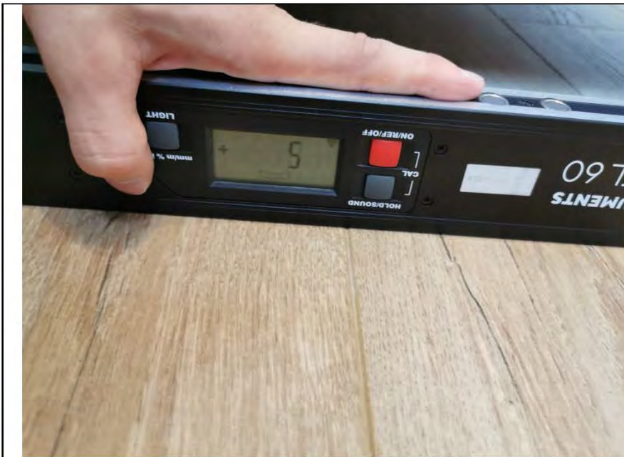
Фото №25. Измерение уровня пола в спальне.
