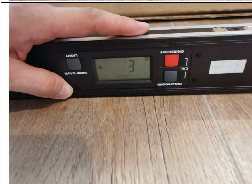
Фото №26. Измерение уровня пола в кухне.
