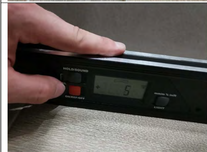
Фото №32. Измерение уровня пола в ванной комнате.
