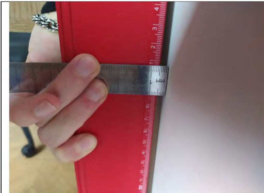
Фото №10. Измерения уровня стен в гостиной.
