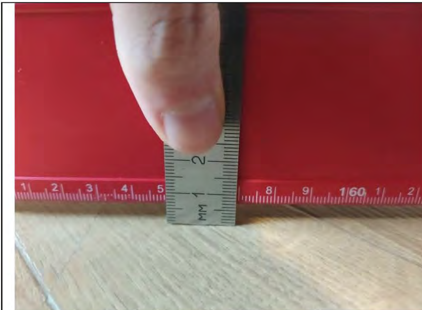
Фото №19. Измерения уровня напольного покрытия в детской.
