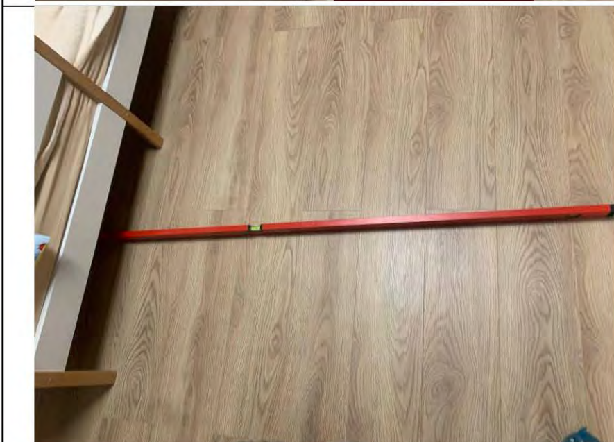
Фото №27 Измерение уровня пола в комнате 1
