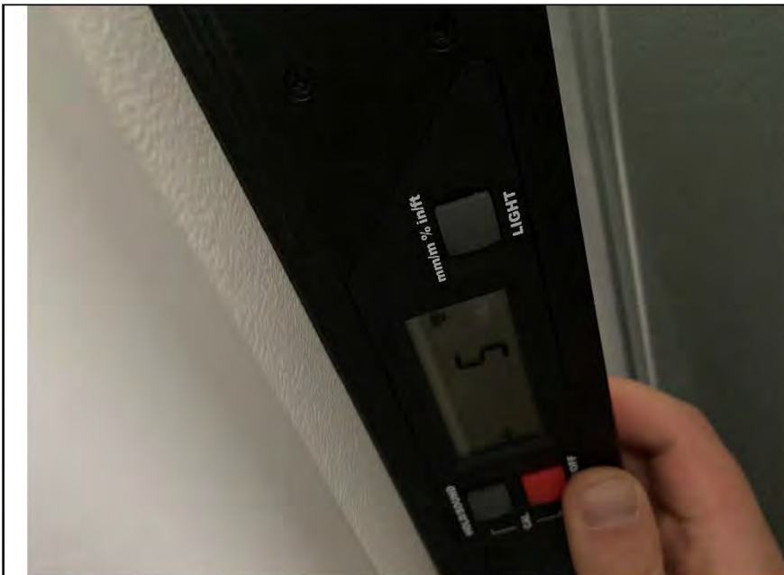
Фото №13. Отклонение поверхности стен от вертикали в кухне.
