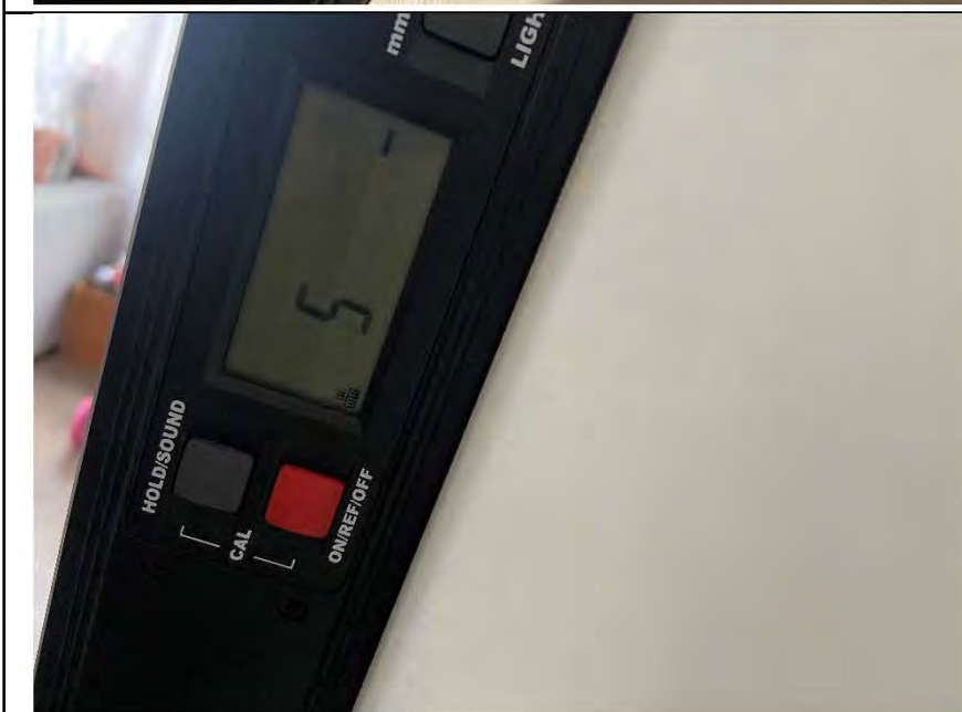
Фото №12. Отклонение поверхности стен от вертикали в детской.
