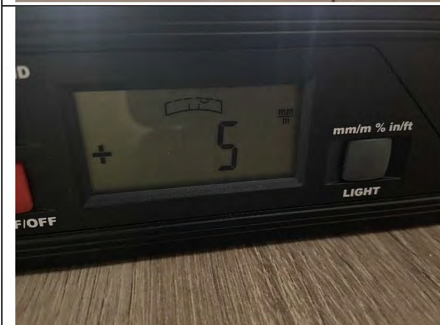
Фото №21. Отклонение поверхности напольного покрытия из ламината в коридоре.
