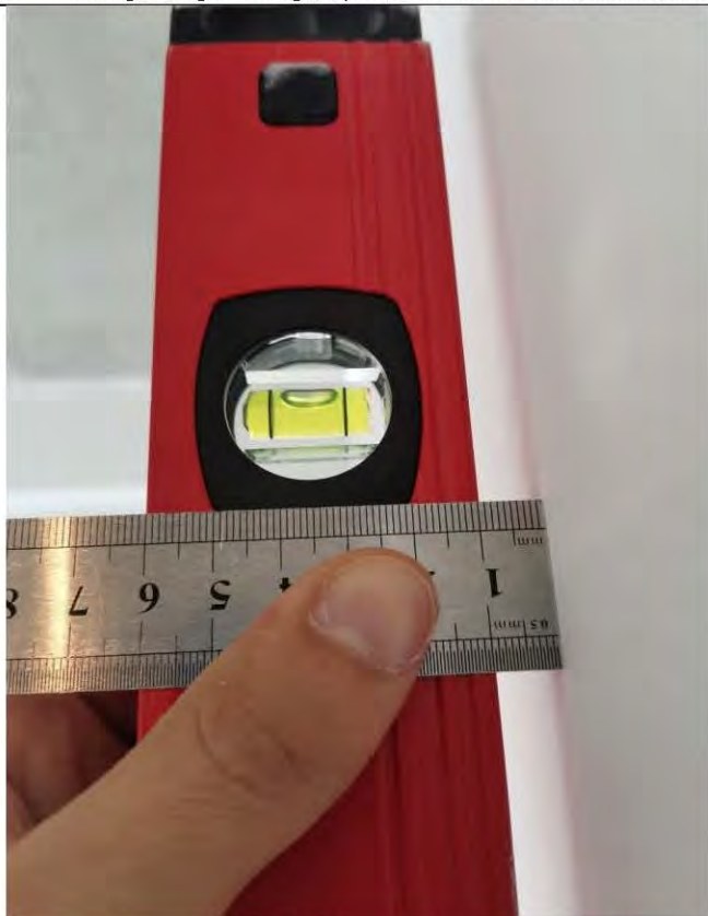
Фото 100-101. Кухня (10,7 кв.м.) 6.2 Отклонение участка стены от вертикали 10 мм
