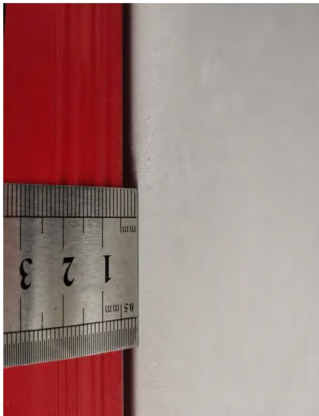
Фото 94-99. Кухня (10,7 кв.м.) 6.1 Отклонение участка стены от горизонтали 5 мм, 6 мм, 4,5 мм
