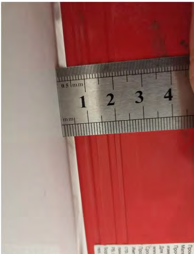
Фото 56-59. Санузел/ванная (3,5 кв.м.) 4.1 Отклонение участка стены от горизонтали 7,5 мм, 4 мм
