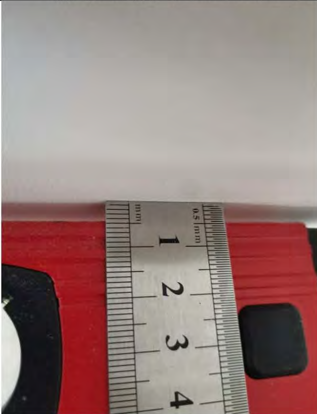
Фото 72-77. Комната 1 (9,8 кв.м.) 5.1 Отклонение участка стены от горизонтали 6,5 мм, 5 мм, 4,5 мм
