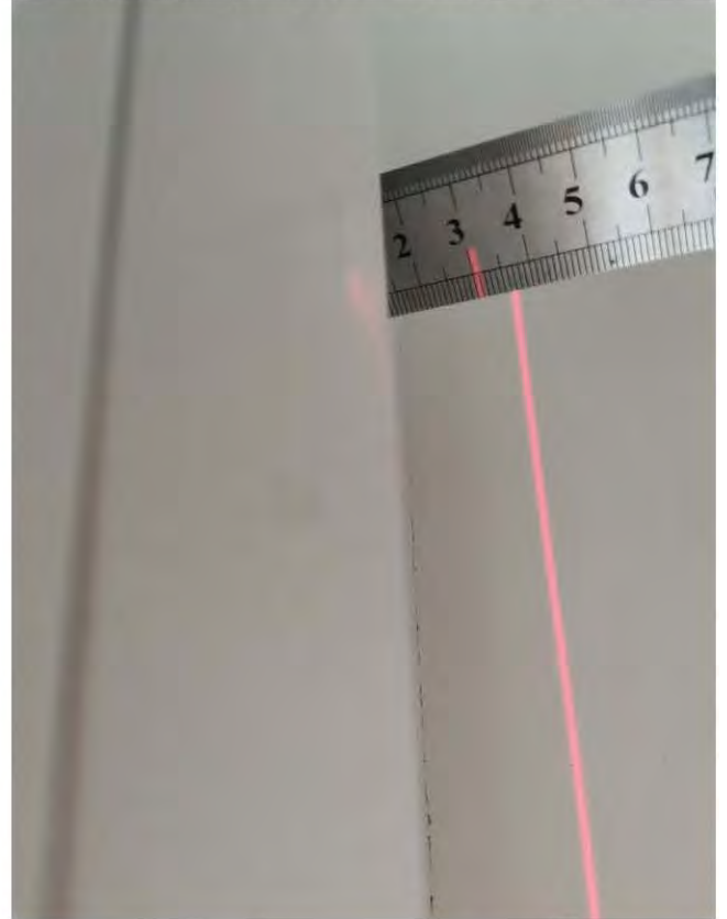
Фото 80-81. Комната 1 (9,8 кв.м.) 5.3 Отклонение оконного блока от вертикали 20 мм
