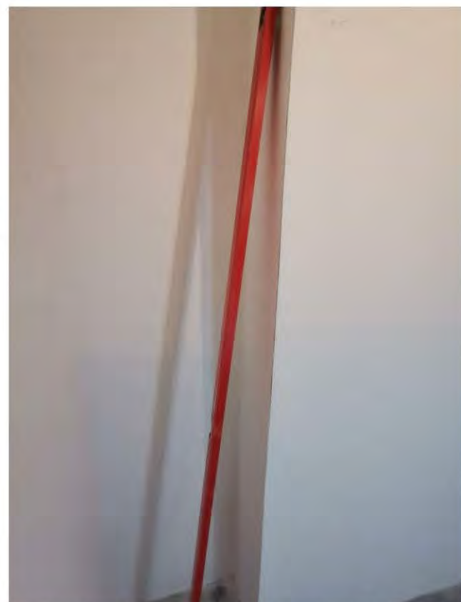
Фото 38-41. Гардеробная (2,1 кв.м.) 2.1 Отклонение участка стены от горизонтали 4,5 мм, 3,5 мм
