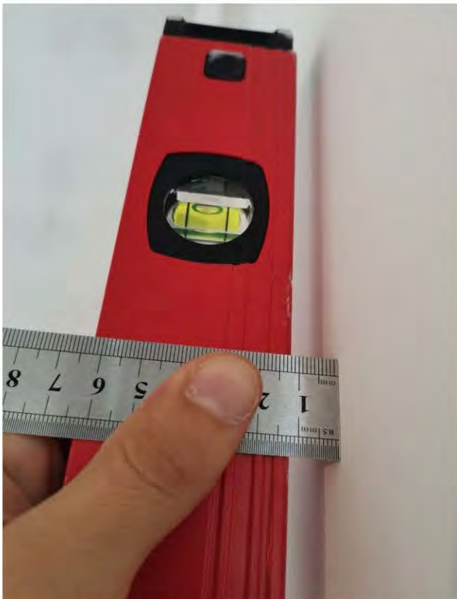
Фото 114-115. Комната 2 (15,5 кв.м.) 7.1 Отклонение участка стены от вертикали 12 мм
