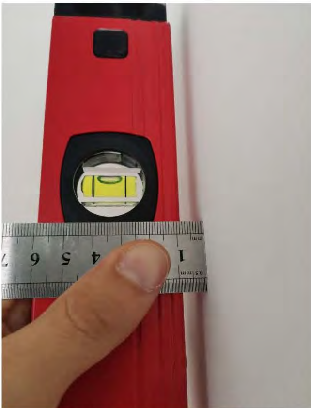
Фото 78-79. Комната 1 (9,8 кв.м.) 5.2 Отклонение участка стены от вертикали 9 мм
