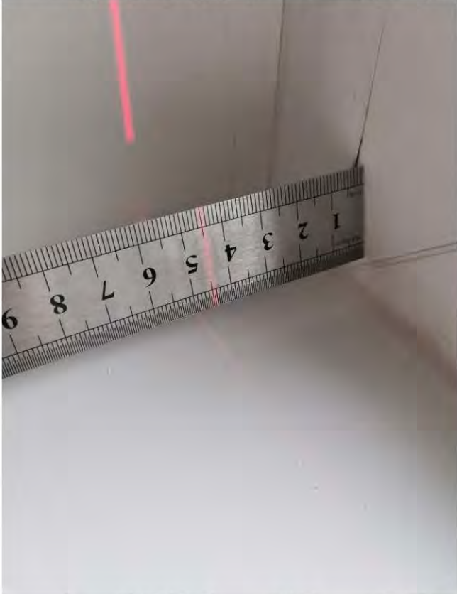
Фото 104-105. Кухня (10,7 кв.м.) 6.4 Отклонение оконного блока от вертикали 20 мм
