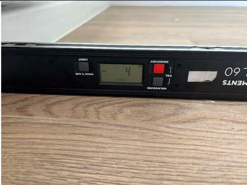
Фото №26. Измерение уровня напольного покрытия в гостиной.
