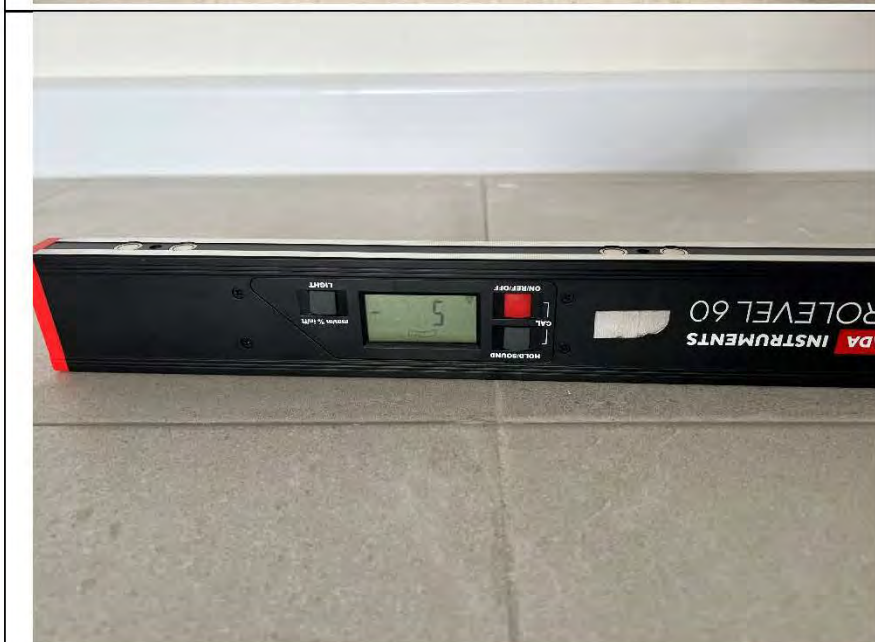
Фото №29. Измерение уровня напольного покрытия в кухне.
