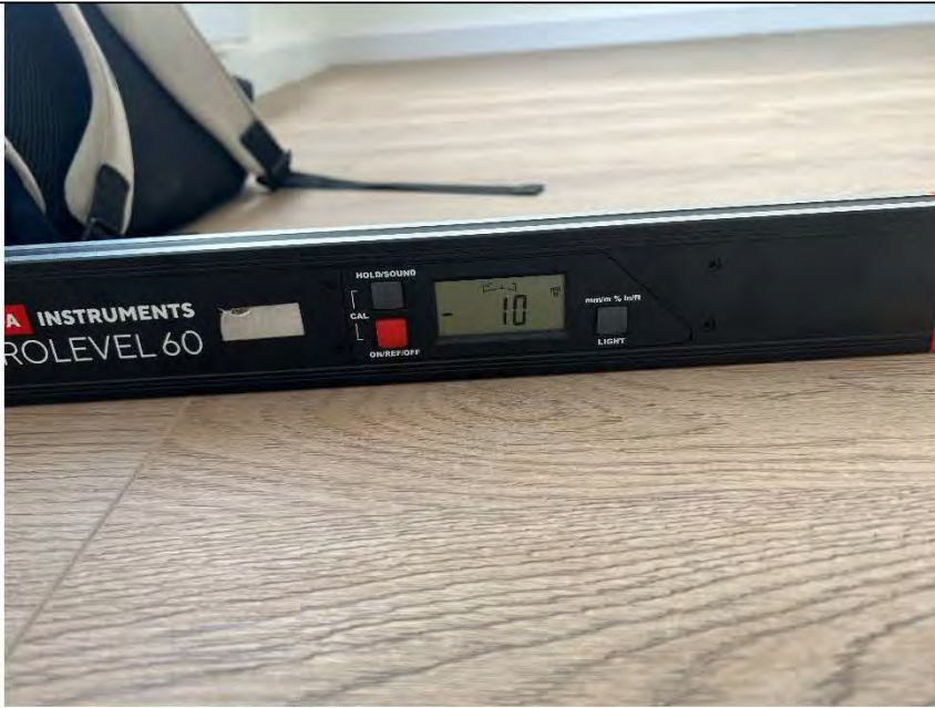
Фото №25. Измерение уровня напольного покрытия в спальне.
