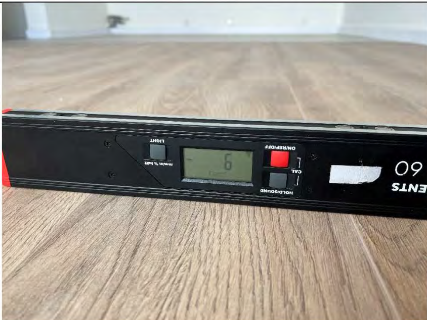
Фото №27. Измерение уровня напольного покрытия в кухне.
