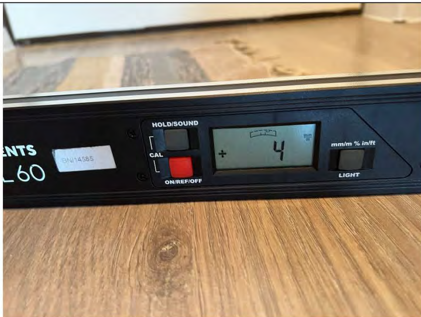
Фото №16. Измерение уровня напольного покрытия в прихожей.
