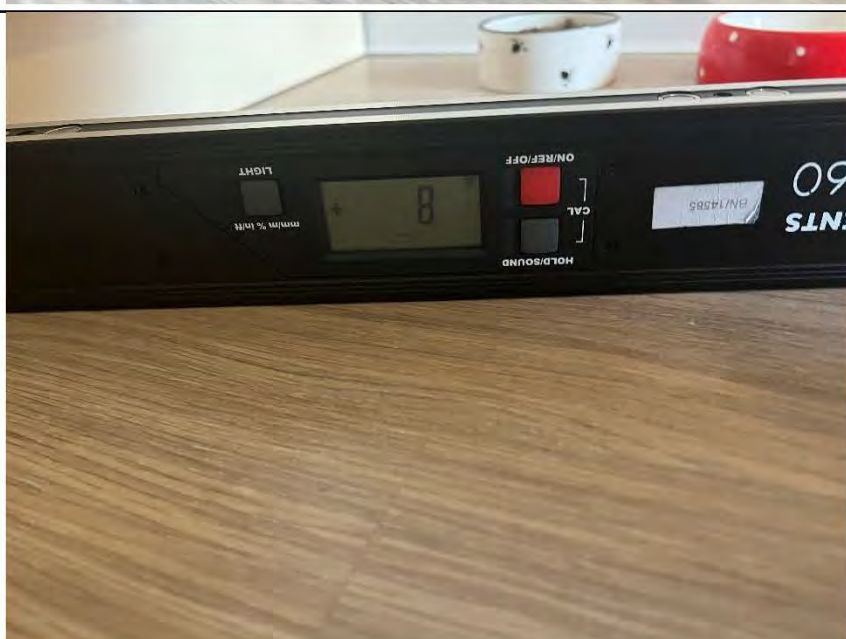
Фото №18. Измерение уровня напольного покрытия в кухне.
