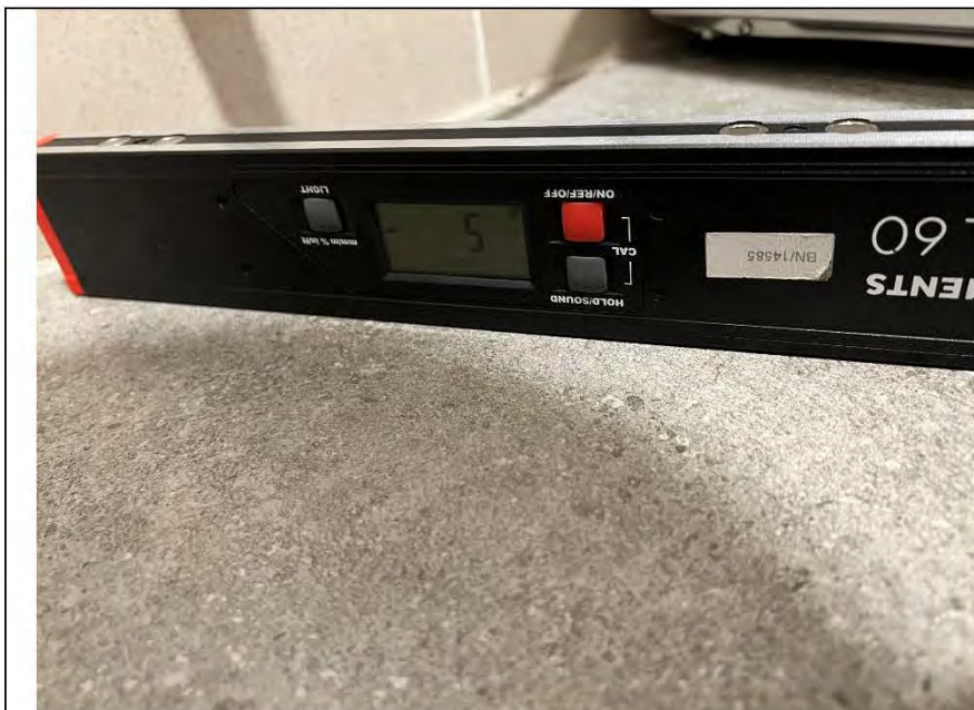
Фото №19. Измерение уровня напольного покрытия в ванной комнате.
