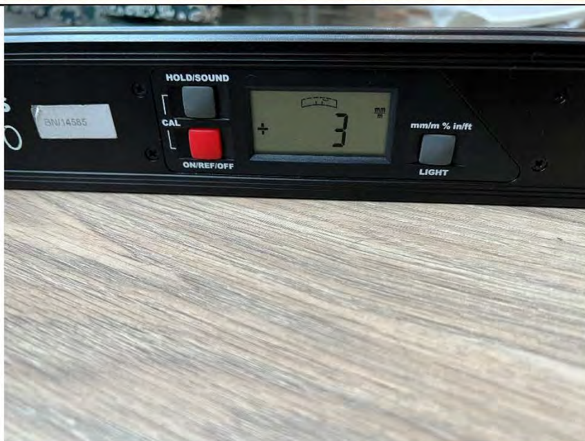
Фото №17. Измерение уровня напольного покрытия в спальне.
