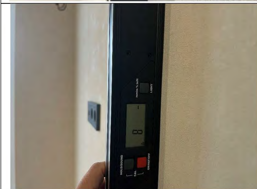
Фото №9. Измерение уровня стен в кухне.
