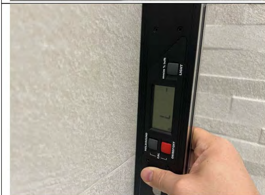
Фото №20. Измерение уровня стен в ванной комнате.
