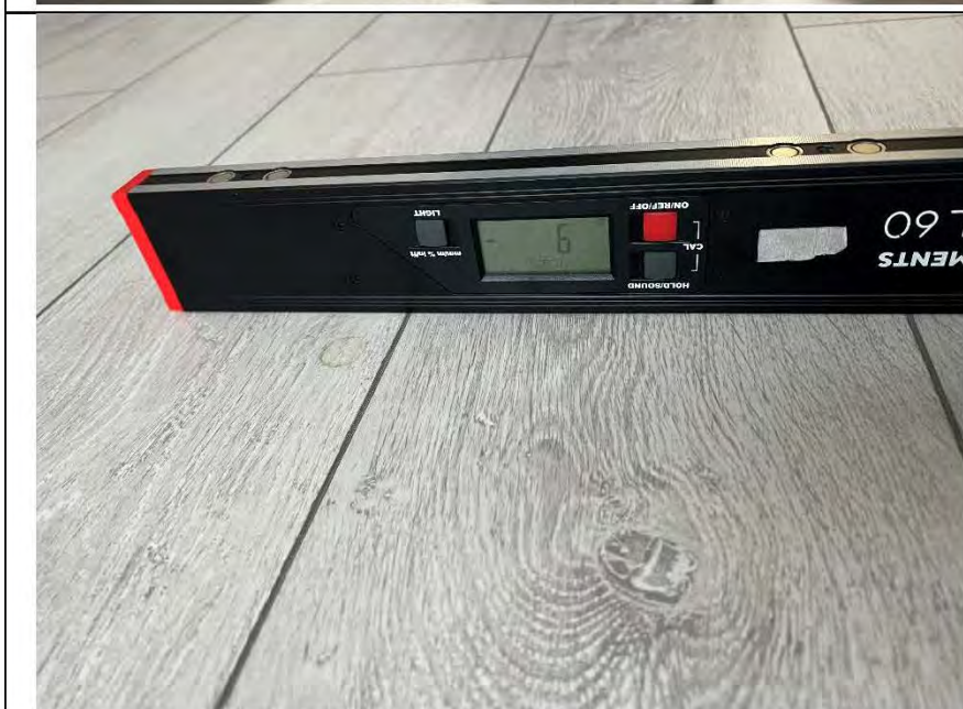
Фото №27. Измерение уровня напольного покрытия в спальне.
