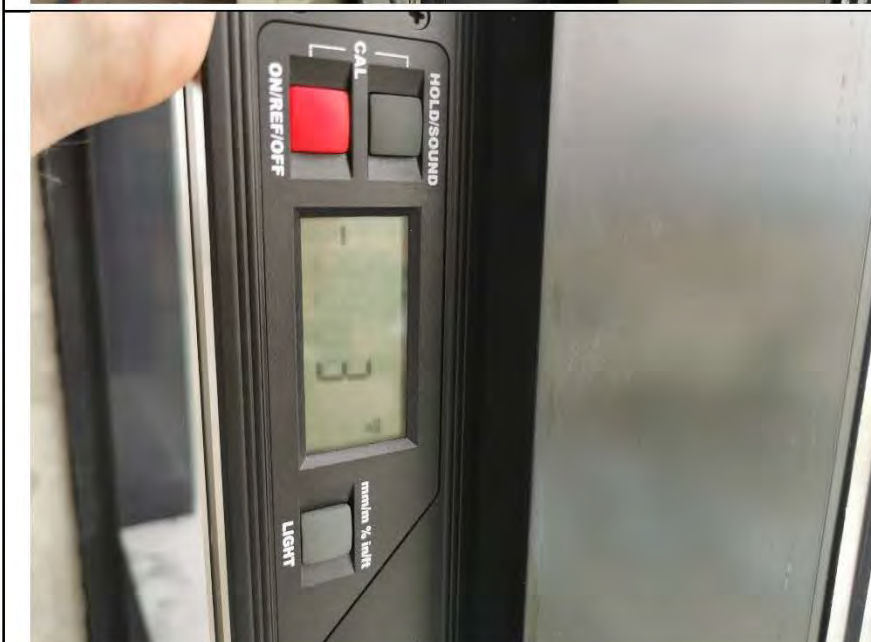
Фото №35. Отклонение металлического оконного блока в детской.
