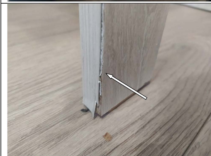
Фото №12. Набухание, отслоение ламинации на ЛДСП панелях стола характерные последствиям залития.
