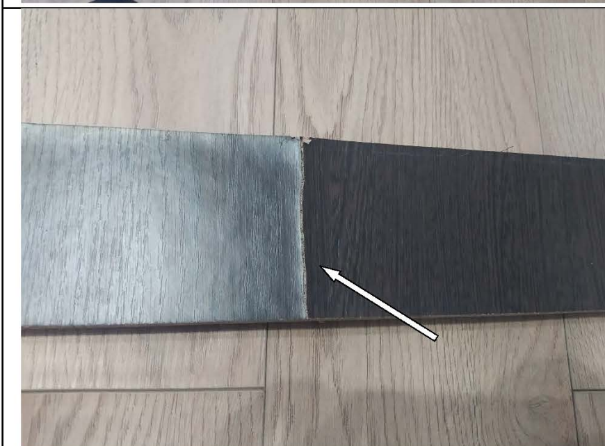
Фото №9. Набухание, трещины на ламинации на ЛДСП панелях цоколя кухонного гарнитура характерные последствиям залития.
