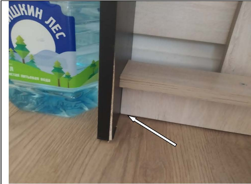
Фото №13. Набухание, отслоение ламинации на ЛДСП панелях тумбы под телевизор характерные последствиям залития.
