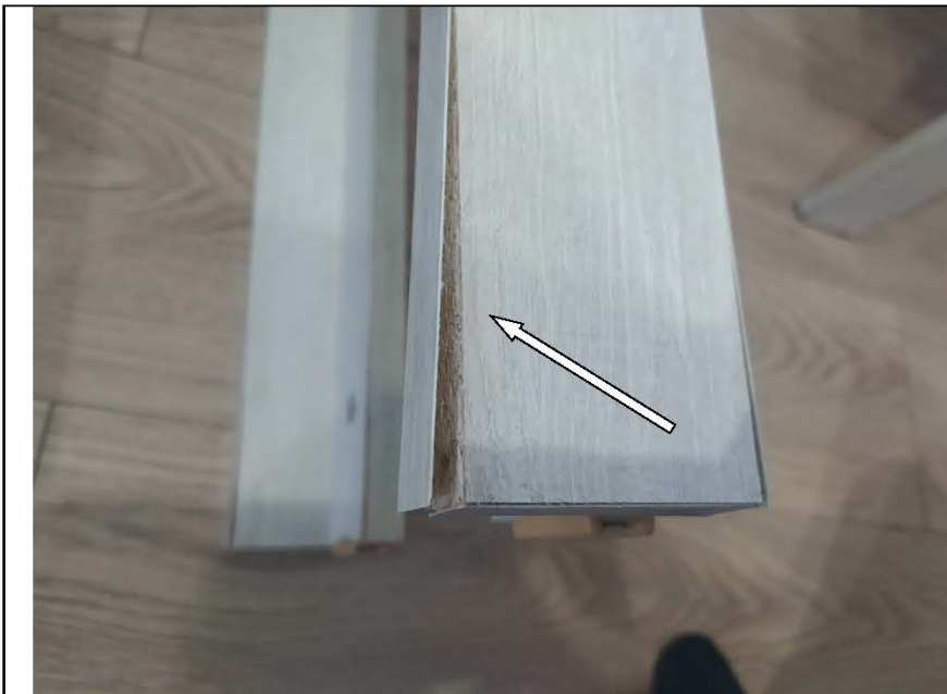
Фото №10. Отслоение ламинации на ЛДСП панелях стула №1 характерное последствиям залития.
