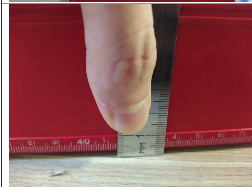
Фото №12. Измерения уровня напольного покрытия в гостиной.
