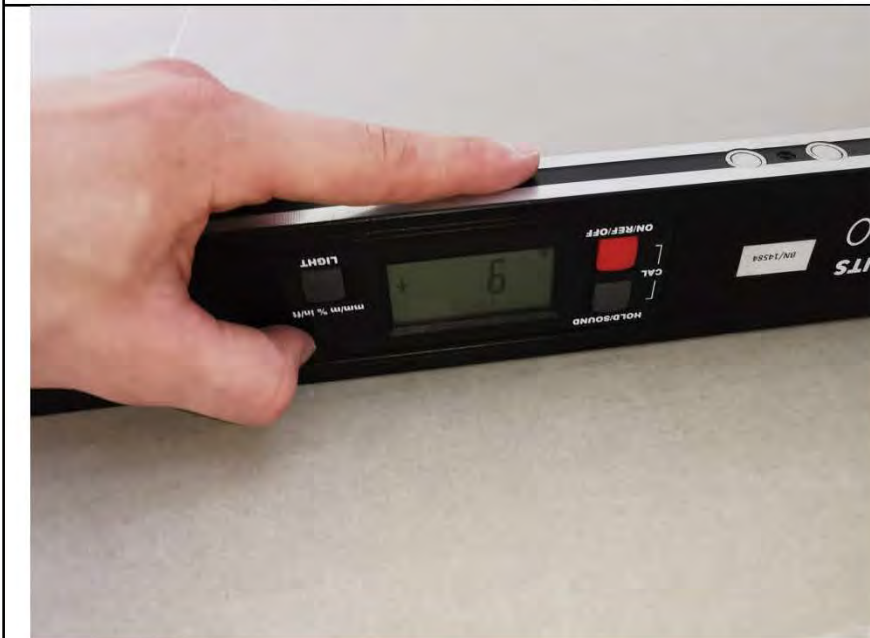
Фото №44. Измерение уровня пола в кухне.
