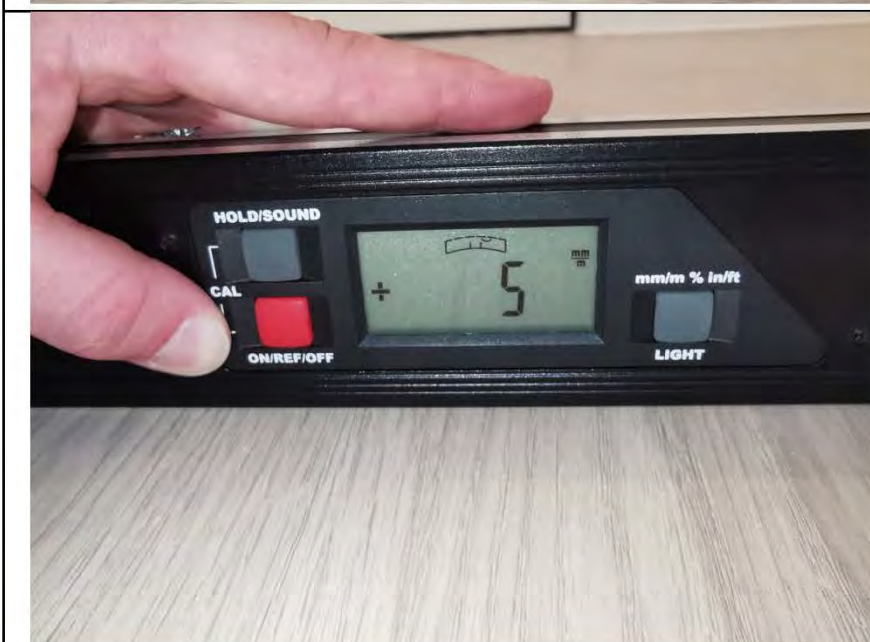
Фото №38. Измерение уровня пола в коридоре.
