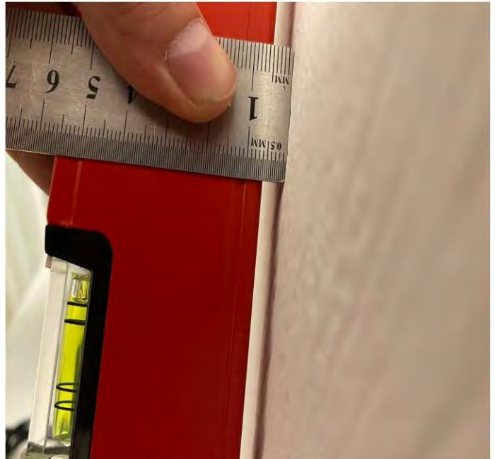
3.1 Отклонения участков стен от горизонтали 6,5 мм, 5,5 мм (Кухня)
