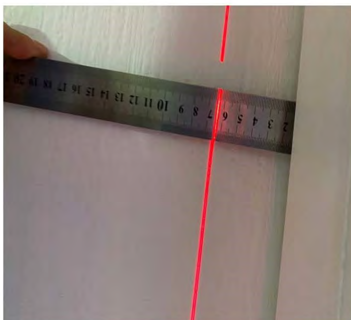
2.7 Отклонение оконного блока от вертикали 5 мм (Комната 1)
