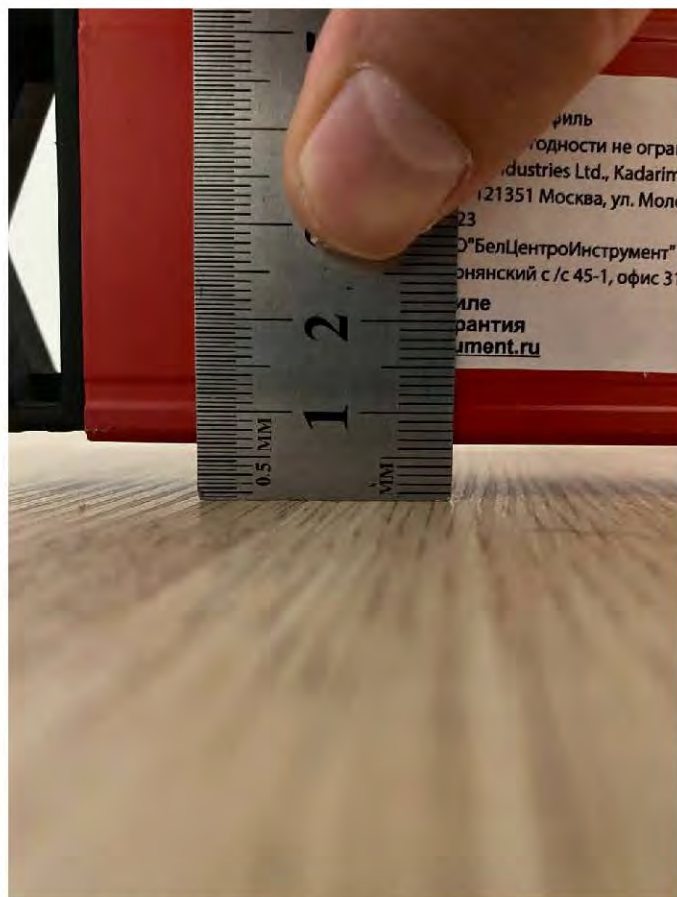
2.8 Отклонение напольного покрытия из ламинированной доски от плоскости 6,5 мм (Комната 1)
