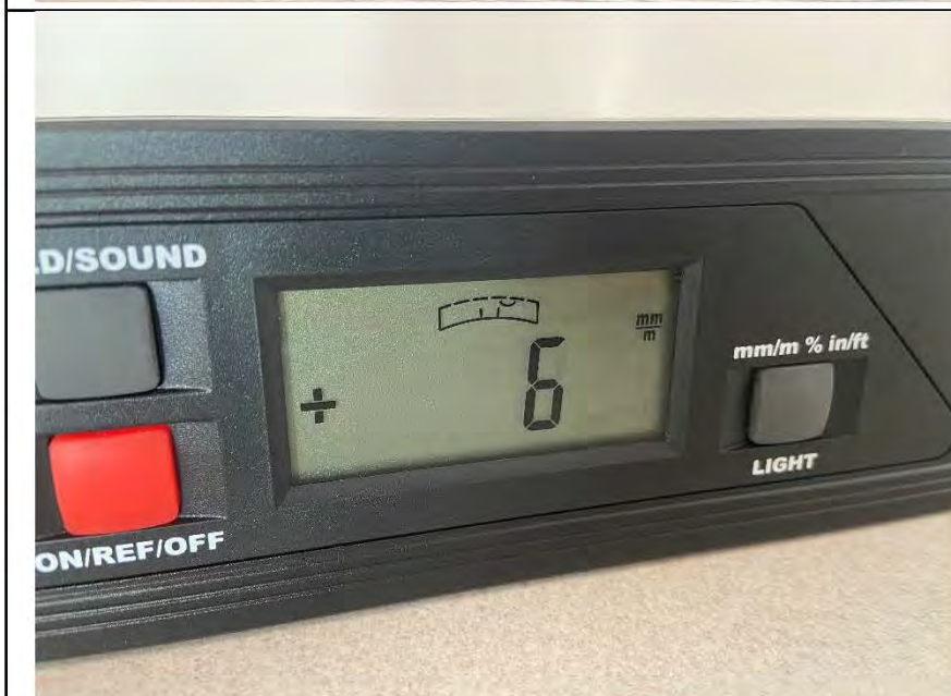
Фото №27. Отклонения поверхности напольного покрытия из керамической плитки в коридоре.
