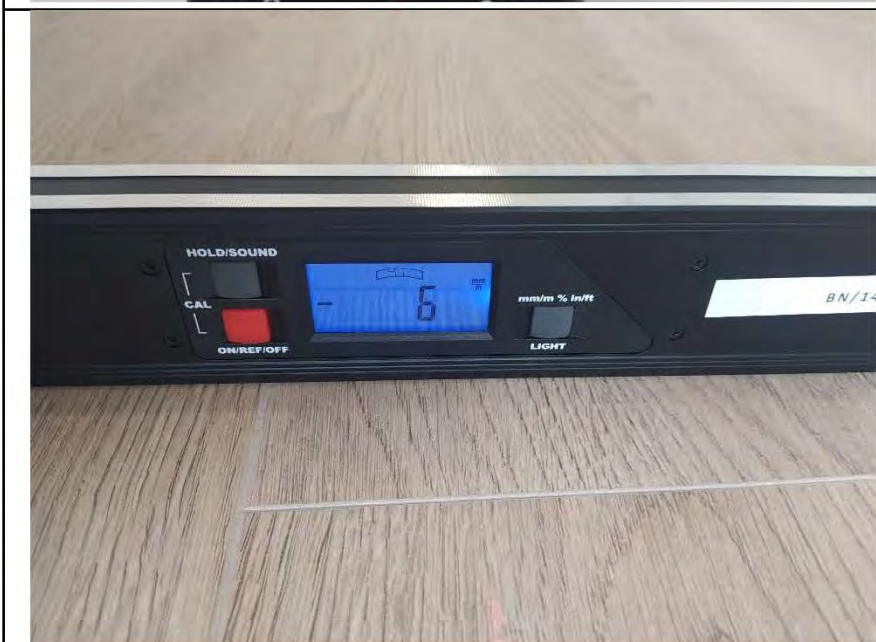
Фото №9. Измерение уровня напольного покрытия в спальне.
