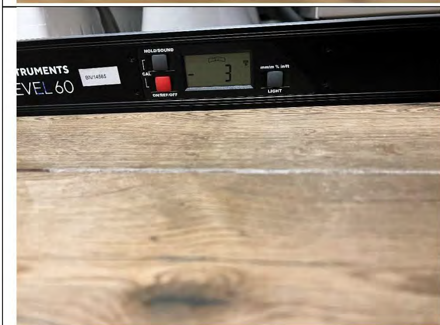
Фото №33. Измерение уровня напольного покрытия в ванной комнате.
