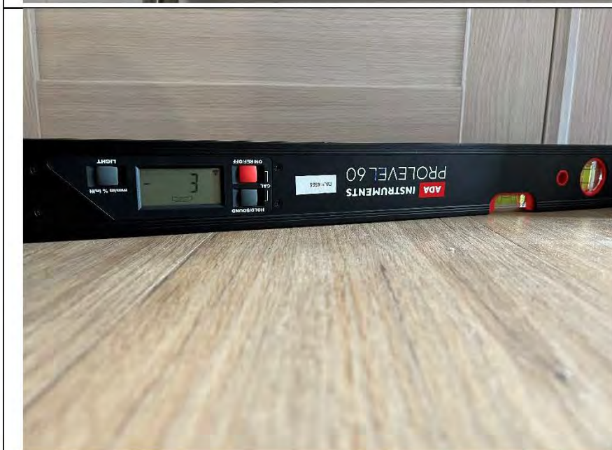
Фото №27. Измерение уровня напольного покрытия в коридоре.
