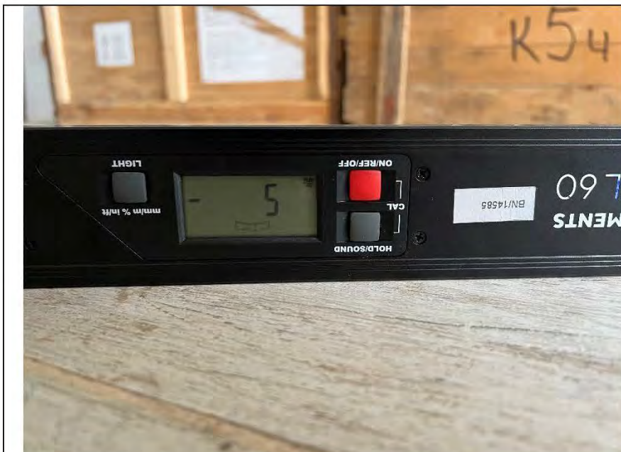
Фото №31. Измерение уровня напольного покрытия в кухне.
