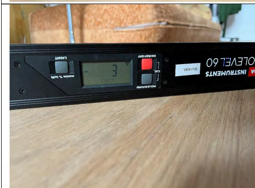
Фото №30. Измерение уровня напольного покрытия в гостиной.
