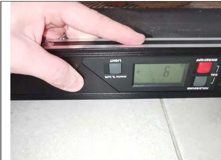
Фото №25. Измерение уровня пола в коридоре.
