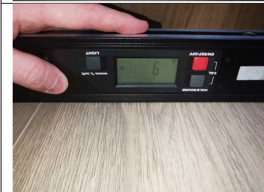
Фото №17. Измерение уровня пола в спальне.
