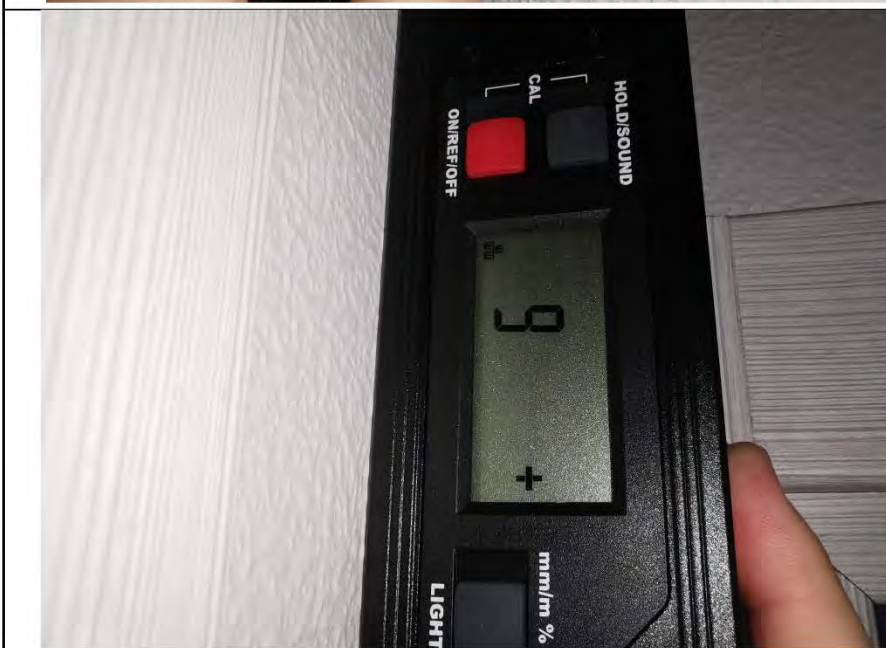
Фото №9. Измерение уровня стен в коридоре.
