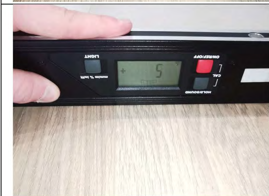
Фото №18. Измерение уровня пола в кухне.
