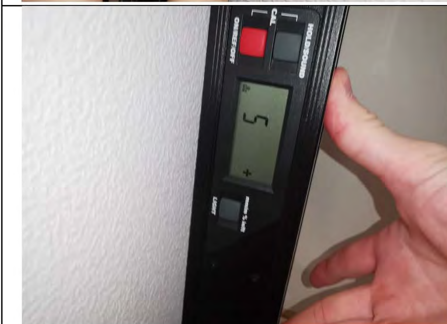
Фото №11. Измерение уровня стен в кухне.
