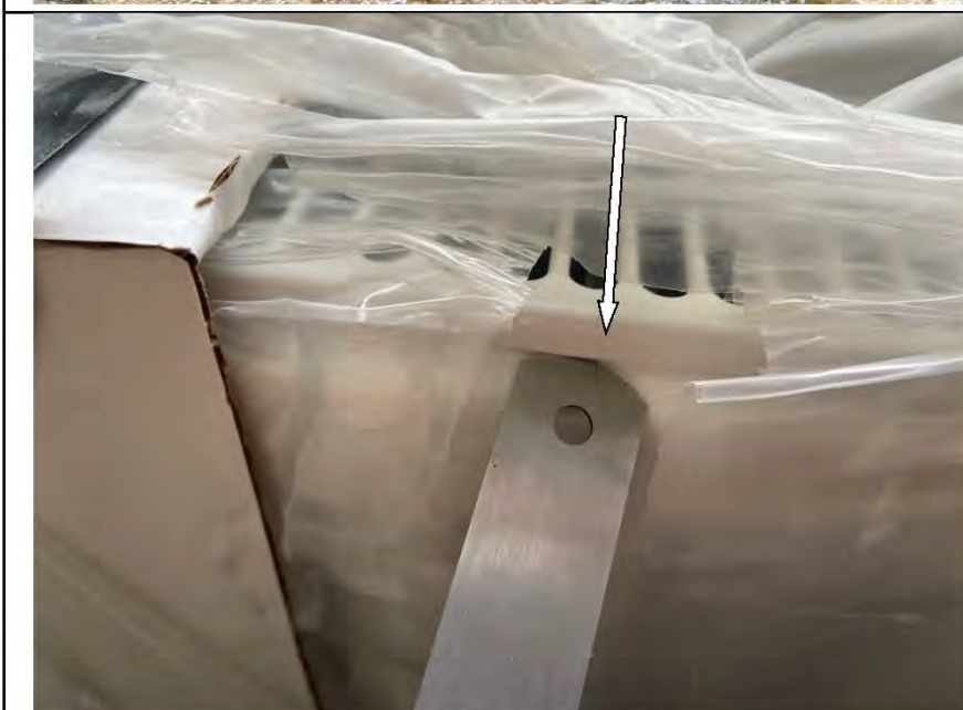
Фото №14. Дефект на поверхности металлического кожуха отопительного прибора в квартире.
